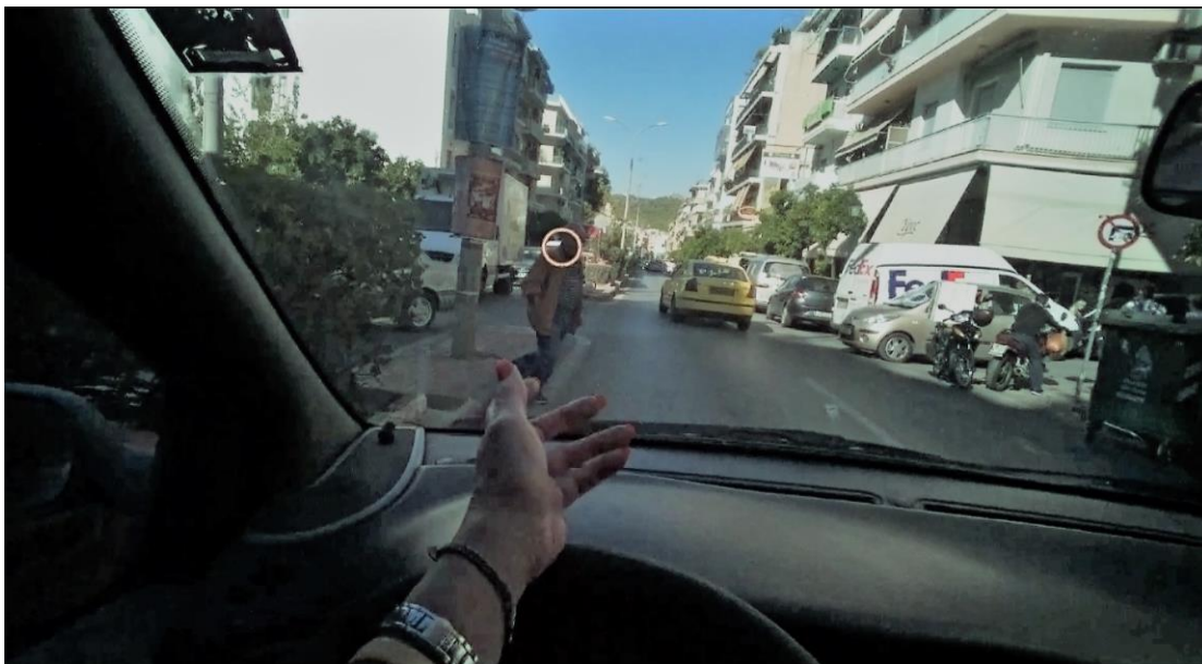
Εικόνα 5α: Παράδειγμα καταγραφής του βλέμματος συμμετέχοντα οδηγού, καθώς ο πεζός ετοιμάζεται να διασχίσει το δρόμο μπροστά από το όχημα του.
