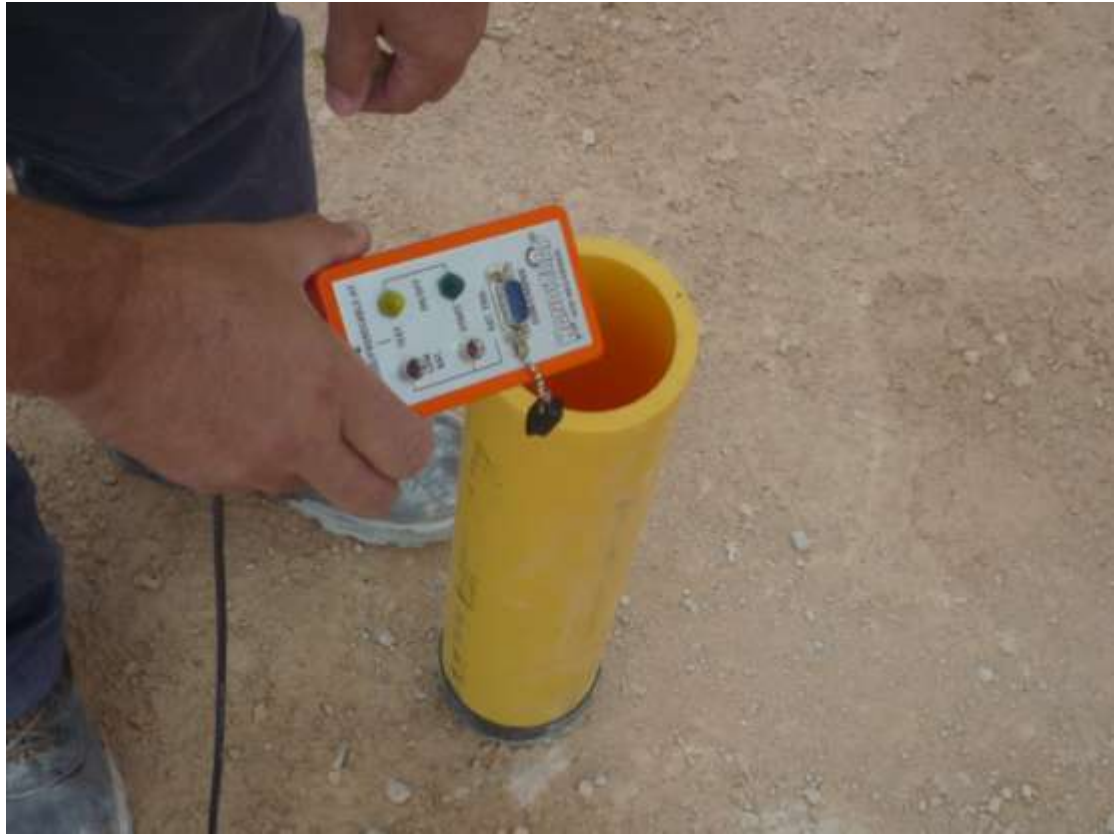
Εικόνα 34 : Το Handytrap τοποθετείται σε πλαστική σωλήνα για προστασία
