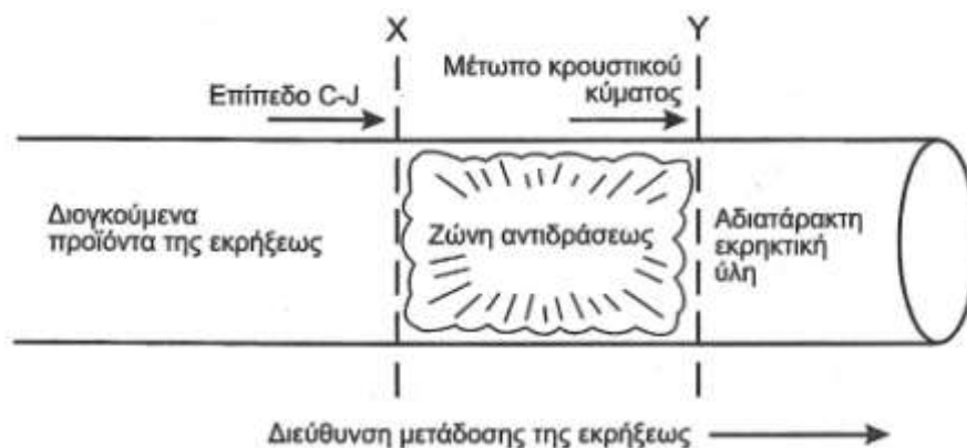
Εικόνα 12: Μοντέλο μετώπου έκρηξης κατά Langweiler
