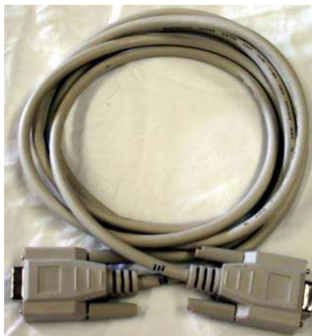
Εικόνα 14 : Καλώδιο επικοινωνίας Handitrap ® με Η/Υ
