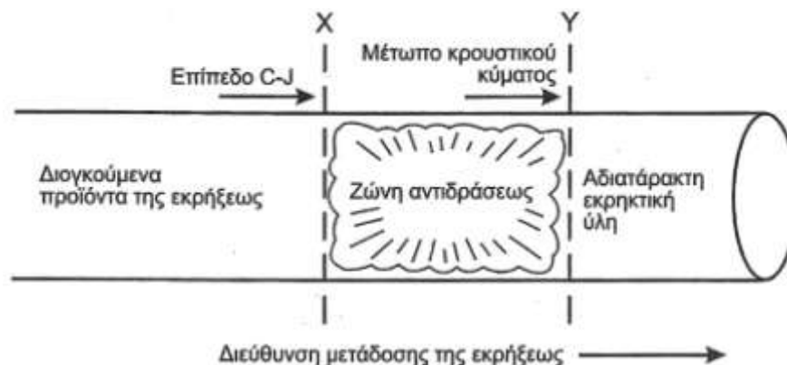
Εικόνα 11: Το μοντέλο του μετώπου της έκρηξης κατά Langweiler
