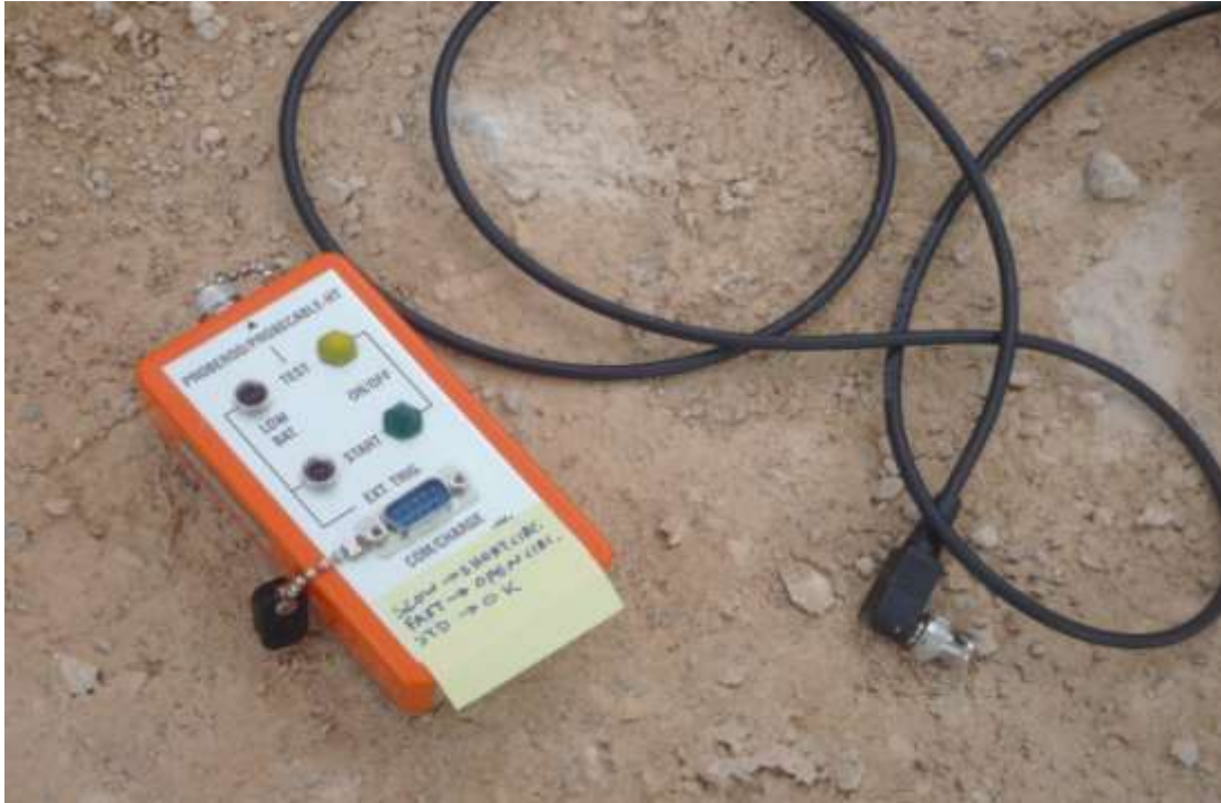
Εικόνα 33 : Ο αντάπτορας BNC συνδέεται με το Handitrap II
