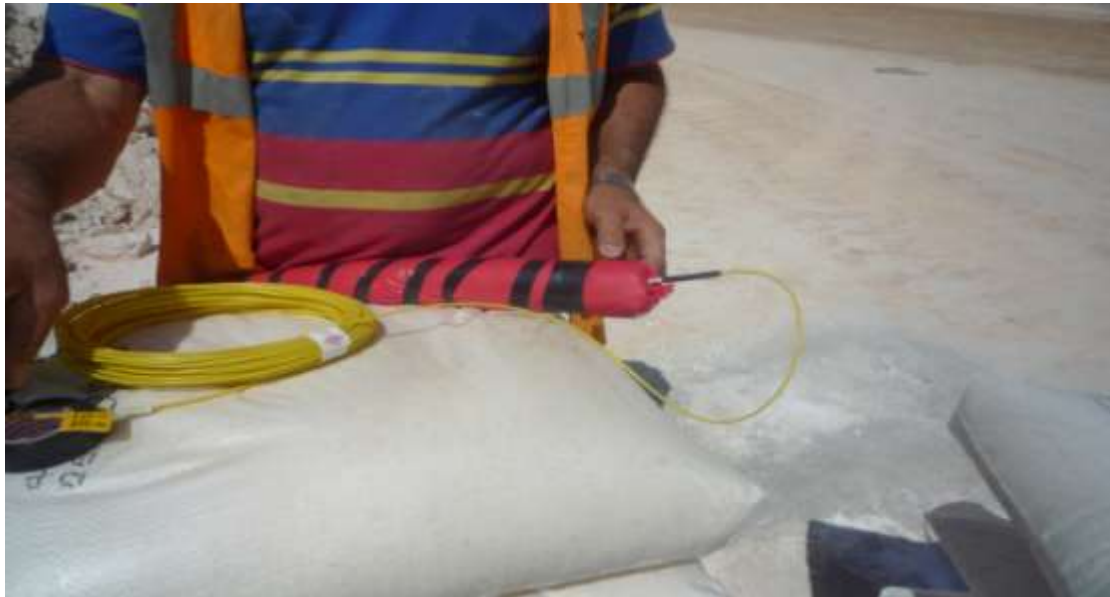
Εικόνα 26: Ο πυροκροτητής Nonel τοποθετείται στο φυσίγγιο της εναυσματικής γόμωσης
