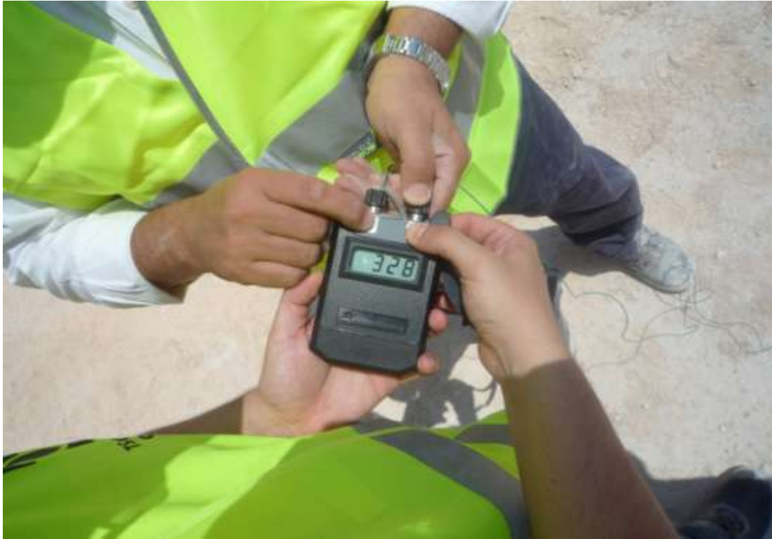
Εικόνα 30 : Μέτρηση της αντίστασης του αισθητήρα PROBLECABLE-HT
