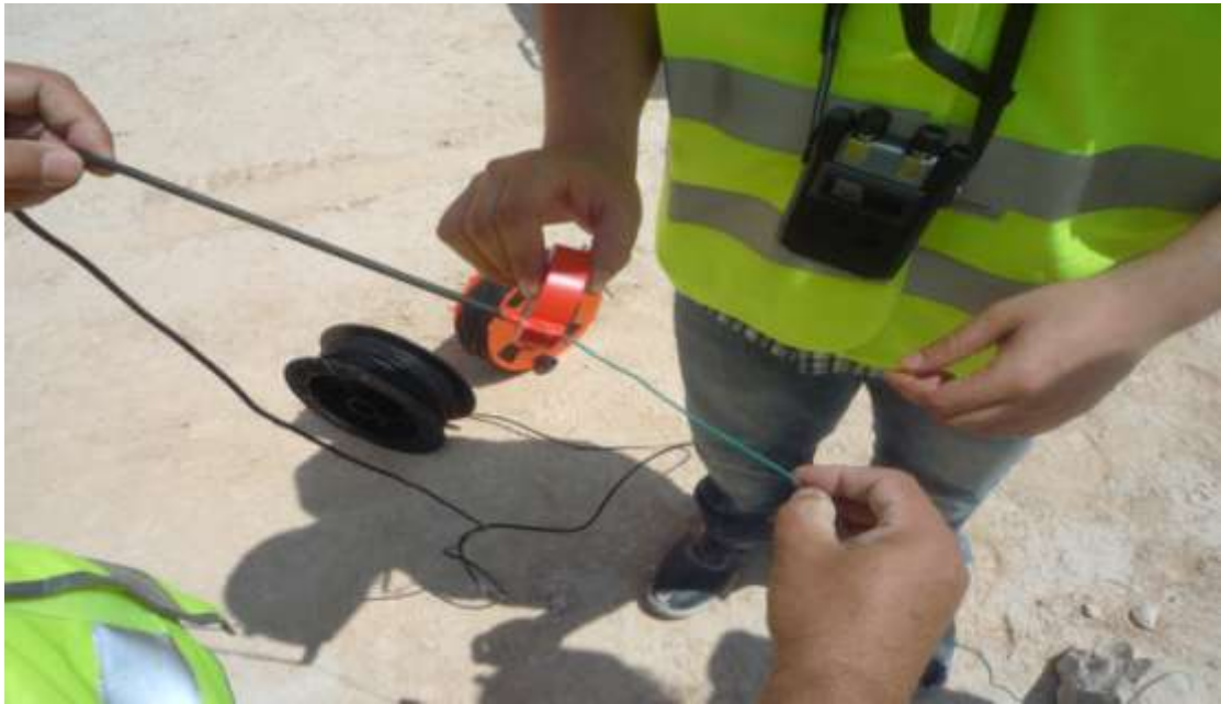
Εικόνα 31 : Ο αισθητήρας PROBLECABLE-HT ενώνεται με τον μονοαξονικό καλώδιο RG-58/U
