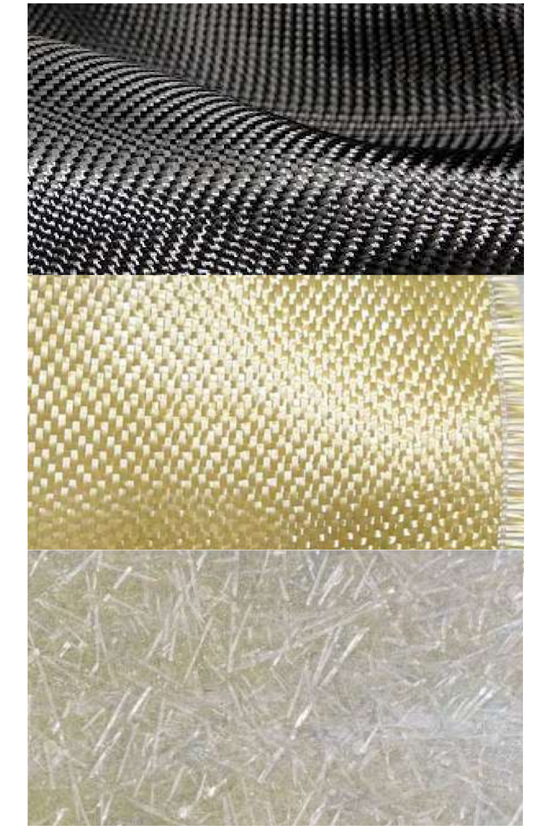
Κατηγορίες υαλοφασμάτων ανάλογα τη πλέξη των ινών τους
