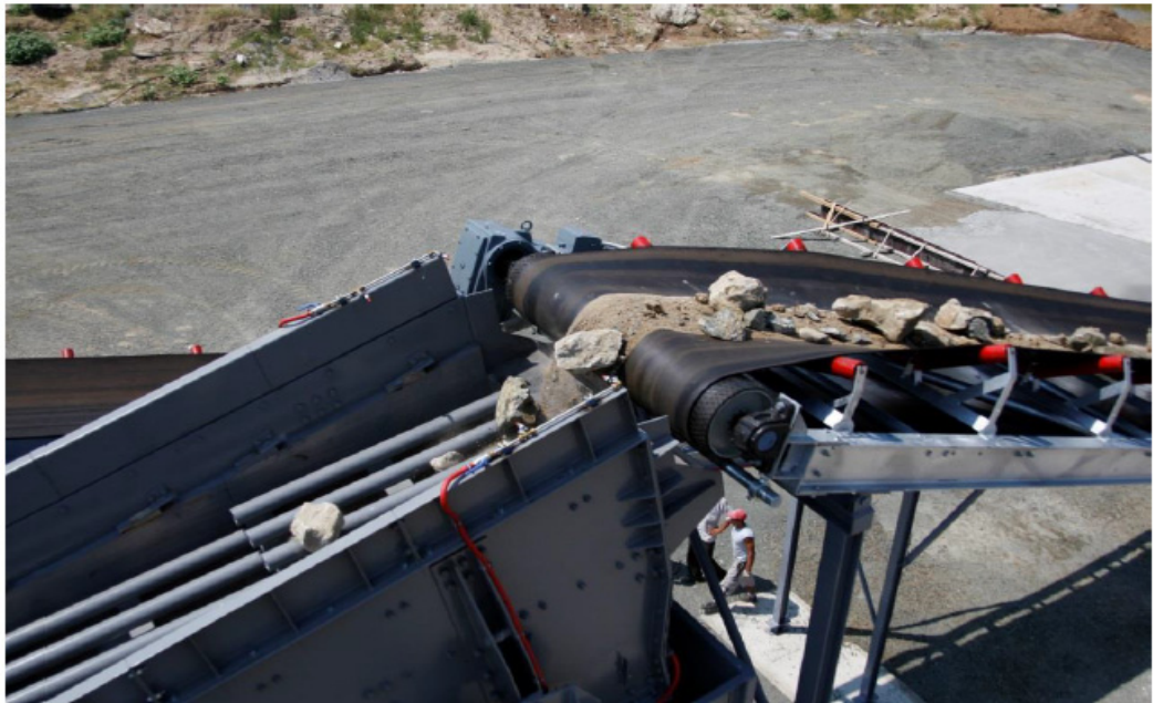
Σχήμα 3.7 - Υλικό πριν τη θραύση και τον κοκκομετρικό διαχωρισμό
