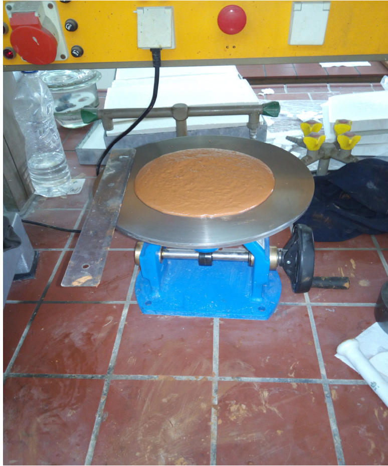
Σχήμα 5.7 – Δοκιμή εργασιμότητας γεωπολυμερούς
