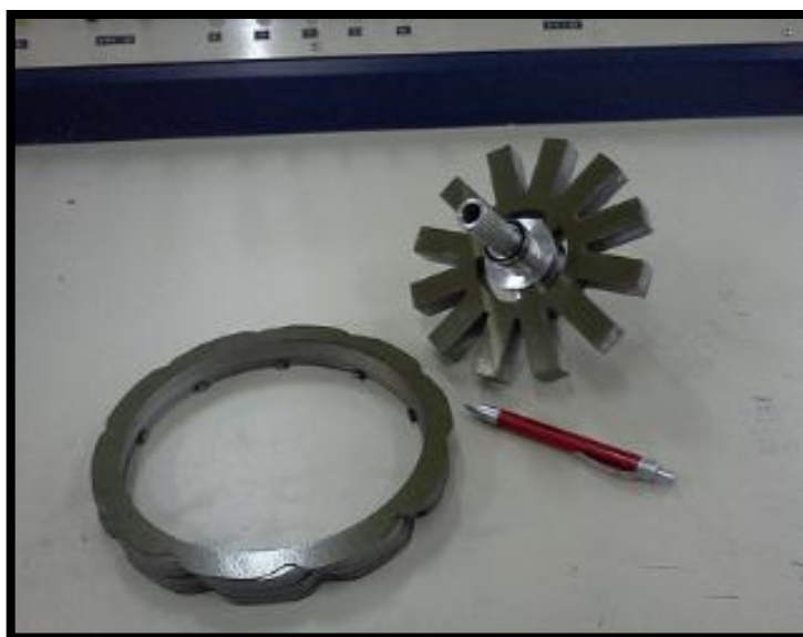
Εικόνα 2 Ο στάτης της μηχανής με τον άξονα και τα φύλλα λαμαρίνας του δρομέα προς σύσφιξη
