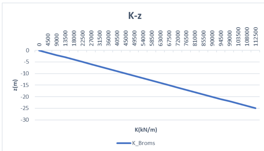
Σχήμα 3.3 Δυσκαμψία ελατηρίων συναρτήσει του βάθους από τον πυθμένα της θάλασσας κατά Broms ( \phi=35 , D=1m )
