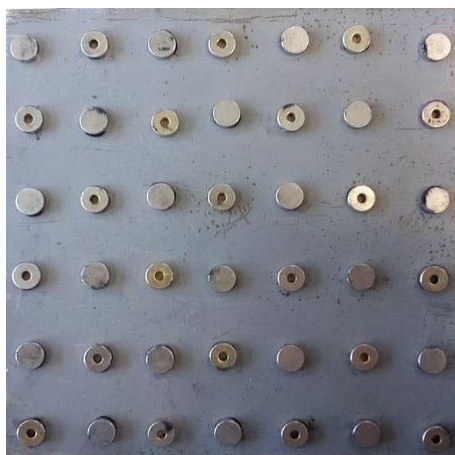
Εικόνα 1.4 Τοποθέτηση μαγνήτων νεοδημίου σε κάναβο πάνω σε μαλακό χάλυβα
