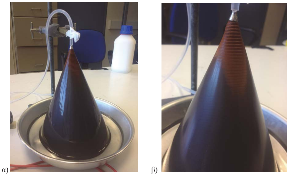
Εικόνα 1.14: α) Κατανομή του υγρού μέσου β) Κατανομή των SPIONs πάνω στην μαγνητική επιφάνεια.
