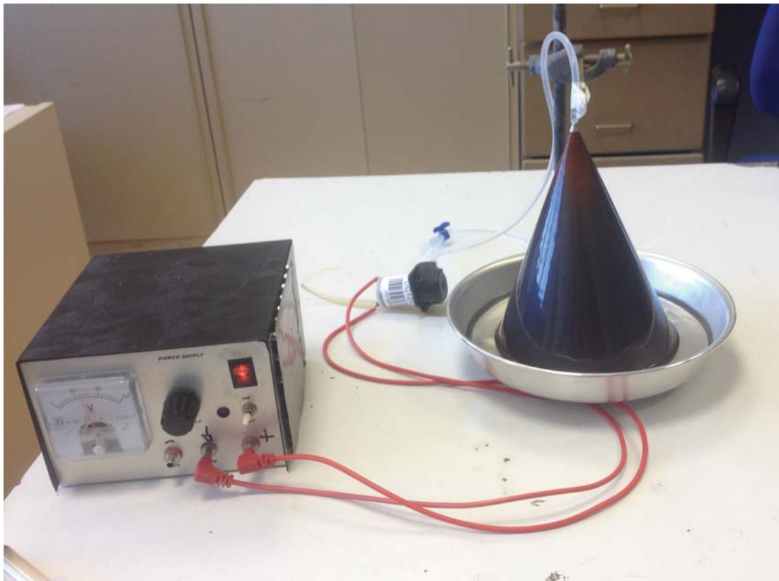
Εικόνα 1.13: Πειραματική διάταξη με τροφοδοτικό, μαγνητική επιφάνεια σχήματος κώνου, περισταλτική αντλία.
