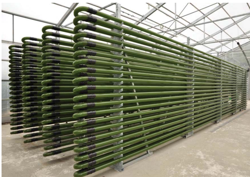
Εικόνα 2.3: Σύστημα σωληνοειδών φωτοβιοαντιδραστήρων σε κάθετη διάταξη [12]
