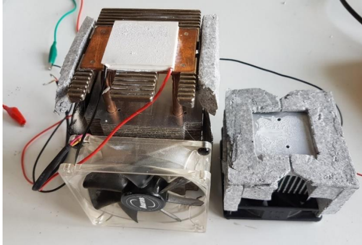
Σχήμα 33. Τοποθέτηση της θερμοεπαγωγικής πάστας και της μονωτικής επιφάνειας.
