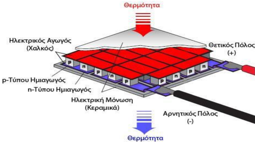
Σχήμα 13. Τυπική δομή θερμοηλεκτρικής γεννήτριας [13]
