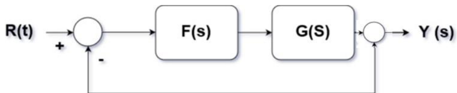
Σχήμα 29. Πρότυπο δομικού διαγράμματος ενός ΣΑΕ.
