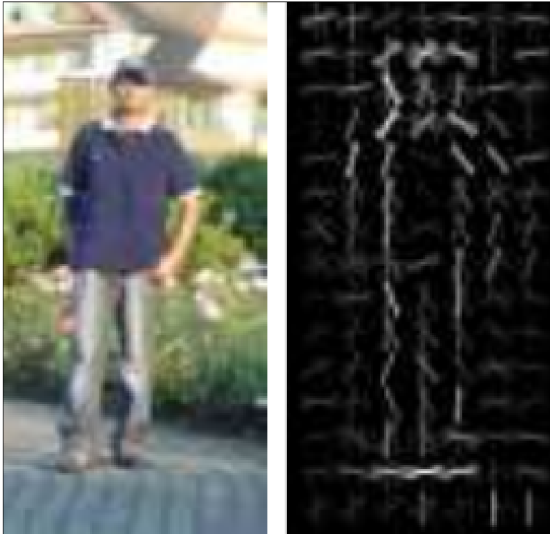
Σχήμα 2.5: Παράδειγμα του περιγραφέα HoG Πηγή: Histograms of Oriented Gradients for Human Detection [21]
