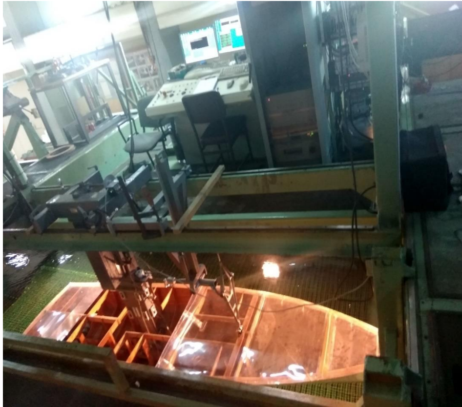
Εικόνα Π ΙΙ. 7 Το φορείο και το προσδεδεμένο μοντέλο 163/01 έτοιμο για πείραμα
