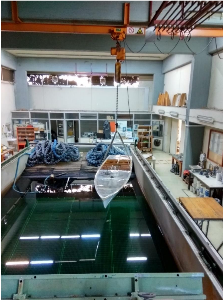
Εικόνα Π ΙΙ. 4 Μεταφορά του προτύπου εντός της δεξαμενής
