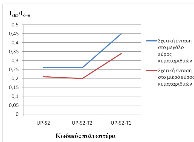
Σχήμα Δ1.14. Σχετική ένταση I_{CH_3}/I_{C=O} σε πολυεστέρες με σταθεροποιητή 0,30 % κ.β.
