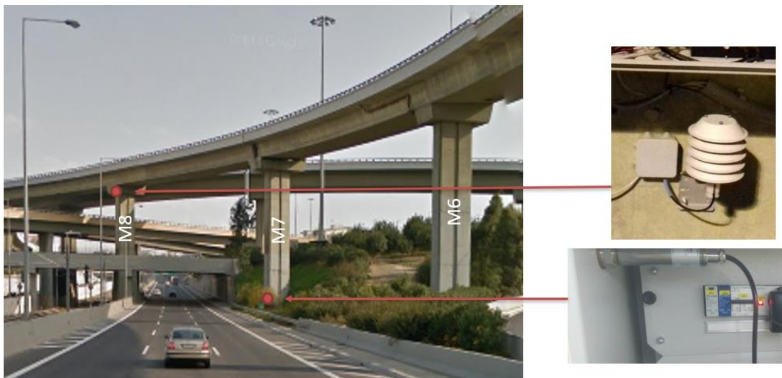
Σχήμα 4. 7: Θέσεις εγκατάστασης των αισθητήρων καταγραφής μετεωρολογικών δεδομένων
