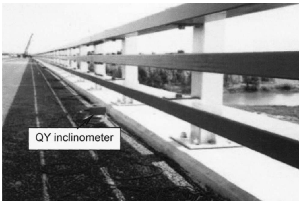
Σχήμα 3. 10: Θέσεις των κλισίμετρων στον φορέα της γέφυρας Figure 3.10: Locations of the inclinometers on the bridge (Πηγή: Hou et. al., 2005)
