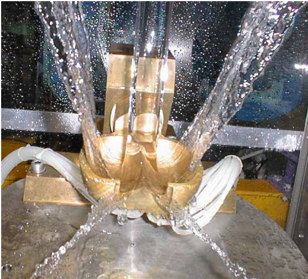
Σχήμα (9): Πειραματική εικόνα πρόσκρουσης δέσμης νερού σε σκαφίδιο LMH-EPFL
