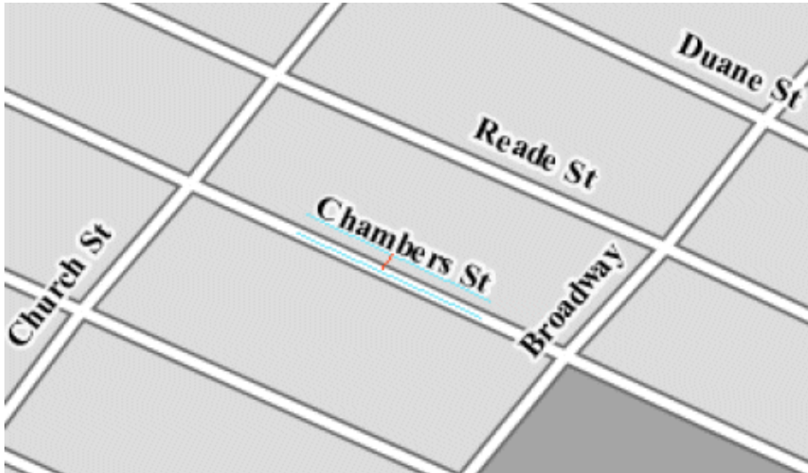
Εικόνα 21: Παράλληλη μετάθεση του ονόματος των οδών σε σχέση με το αντίστοιχο γραμμικό στοιχείο κατά 10 εικονοστοιχεία.
