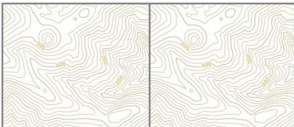
Εικόνα 29: Θέτοντας την τιμή της επιλογής forceLeftToRight σε false (δεξιά) τα τοπωνύμια αναγράφονται ακολουθώντας τη φορά των γραμμικών στοιχείων.
