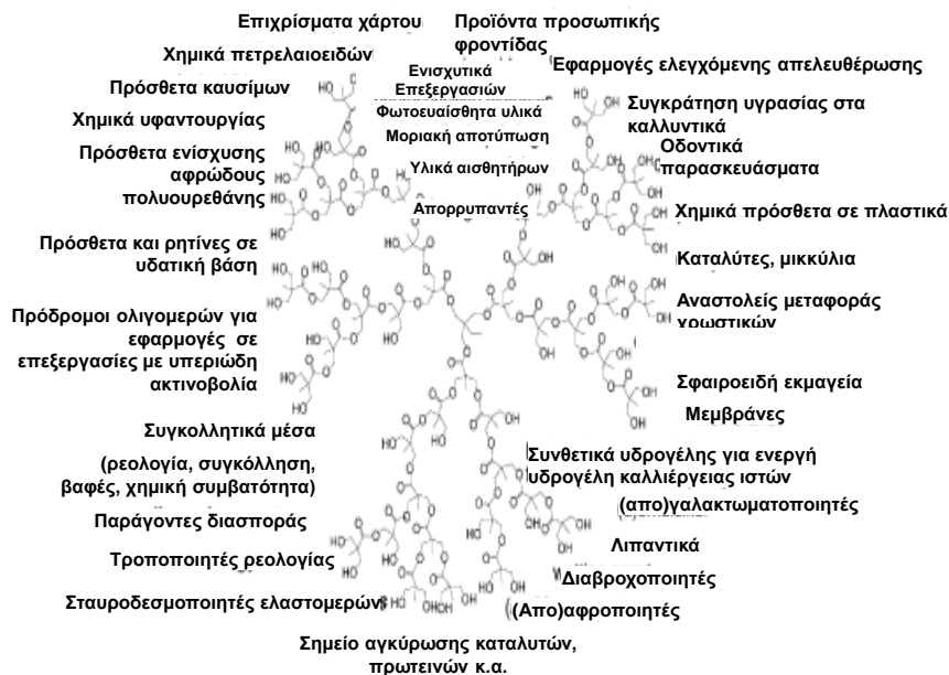
Εικόνα 10: Εφαρμογές υπερδιακλαδισμένων πολυμερών που συναντώνται στη βιβλιογραφία [5].
