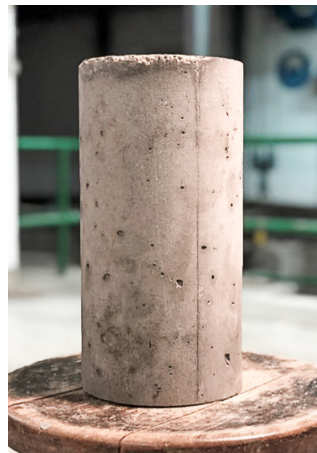
Φωτογραφία 2 Κυλινδρικό δοκίμιο διαμέτρου 150 mm και ύψους 300 mm για τη δοκιμή σε διάρρηξη
