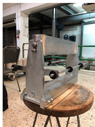
Φωτογραφία 8 Βοηθητική διάταξη κυλινδρικού δοκιμίου για τη δοκιμή σε διάρρηξη
