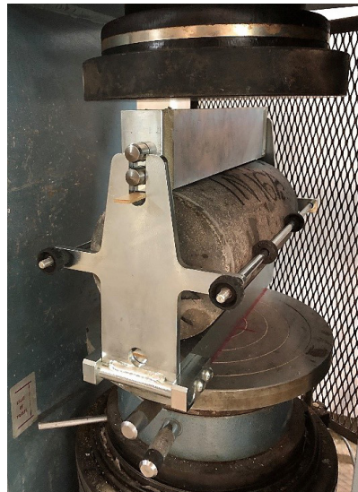
Φωτογραφία 9 Βοηθητική διάταξη με κυλινδρικό δοκίμιο, τοποθετημένα στη μηχανή θραύσης για τη δοκιμή σε διάρρηξη
