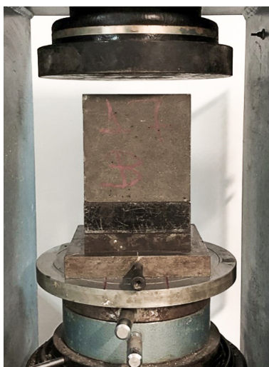
Φωτογραφία 5 Κυβικό δοκίμιο τοποθετημένο στη μηχανή θραύσης για τη δοκιμή σε θλίψη
