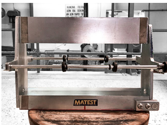
Φωτογραφία 8 Βοηθητική διάταξη κυλινδρικού δοκιμίου για τη δοκιμή σε διάρρηξη
