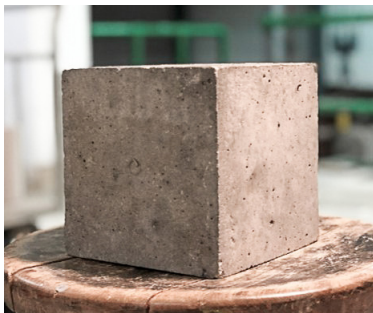
Φωτογραφία 1 Κυβικό δοκίμιο ακμής 150 mm για τη δοκιμή σε θλίψη
