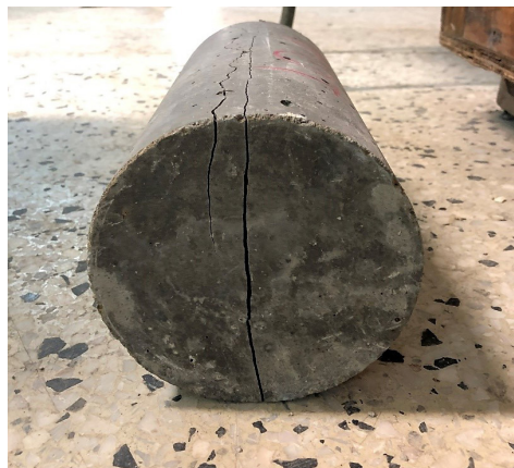
Φωτογραφία 12 Θραύση κυλινδρικού δοκιμίου (με σφήνα)
