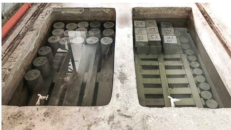
Φωτογραφία 3 Δεξαμενές για τη συντήρηση των κυβικών και κυλινδρικών δοκιμών στο εργαστήριο σκυροδέματος του Εθνικού Μετσόβιου Πολυτεχνείου
