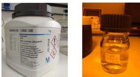
Σχήμα 3.3: Αριστερά: Η χημική συσκευασία της σκόνης Zinc Acetate Dihydrate από την εταιρία Merck. Δεξιά: Παρασκευασμένο διάλυμα (80mL) sol-gel συγκέντρωσης 40 mM
