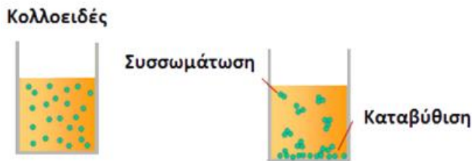
Σχήμα 3.2: Καταβύθιση ενός κολλοειδούς.
