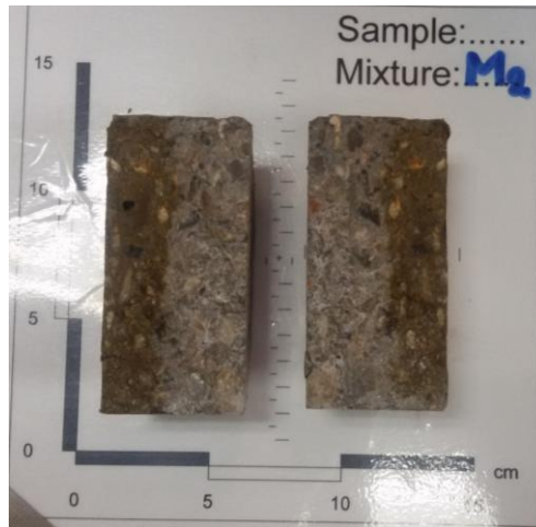
Σχήμα 5.14: Εικόνα δοκιμίου ελέγχου της σύνθεσης M2 μετά από ψεκασμό με νιτρικό άργυρο για τη μέτρηση του βάθους διείσδυσης των χλωριόντων.
