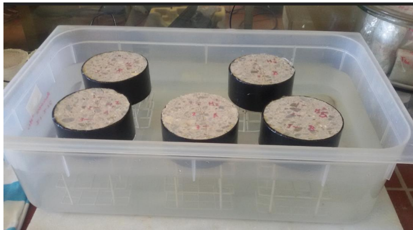
Σχήμα 4.6: Τοποθέτηση δοκιμίων πάνω σε μεταλλικά στηρίγματα μέσα σε δοχείο με νερό για την μέτρηση της υδατοαπορροφητικότητας.
