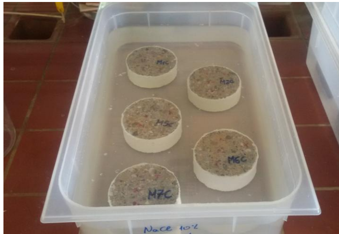
Σχήμα 4.12: Τοποθέτηση δοκιμίων μετά τη μόνωση τους σε υδατικό διάλυμα 10% NaCl.
