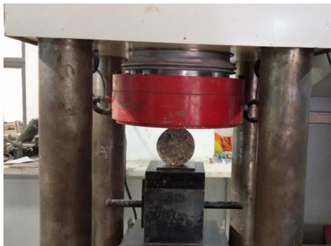
Σχήμα 4.10: Διάταξη που χρησιμοποιήθηκε για το χωρισμό των δοκιμίων ελέγχου σε 2 τεμάχια και των ιασμένων δοκιμίων σε 4 τεμάχια.
