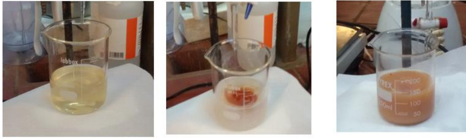
Σχήμα 4.15: Προσθήκη στυπτηρίας μέχρι το χρωματισμό του διαλύματος.
