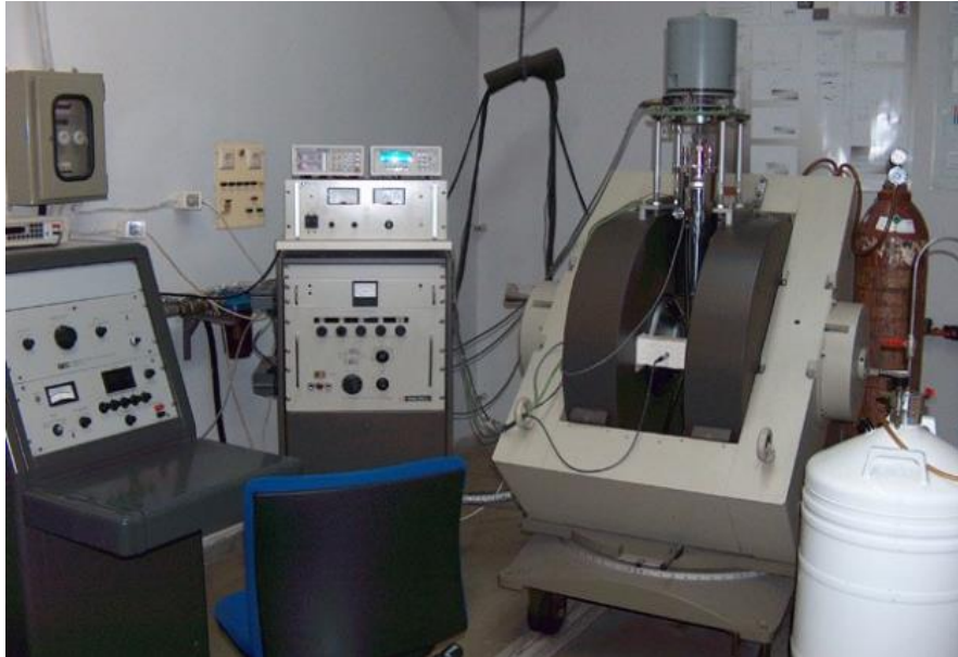
Εικόνα 6.13 Διάταξη μαγνητόμετρου δονούμενου δείγματος
