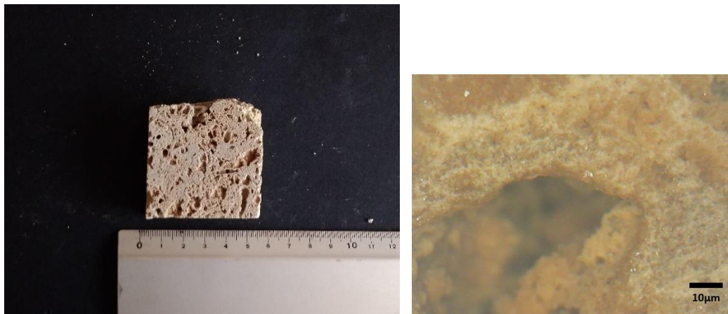
Εικόνα 43. Μακροσκοπική φωτογραφία δοκιμίου PL_PH_1.1 (αριστερά), μικροσκοπική φωτογραφία δοκιμίου PL_PH_1.1 με FOM, μεγέθυνσης x50 (δεξιά)
