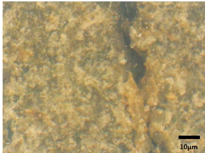
Εικόνα 40. Μικροσκοπική φωτογραφία δοκιμίου PL_SH_2.5 με FOM, μεγέθυνσης όπου φαίνεται ο ερυθρός χρωματισμός καθώς και ρωγμή του δοκιμίου
