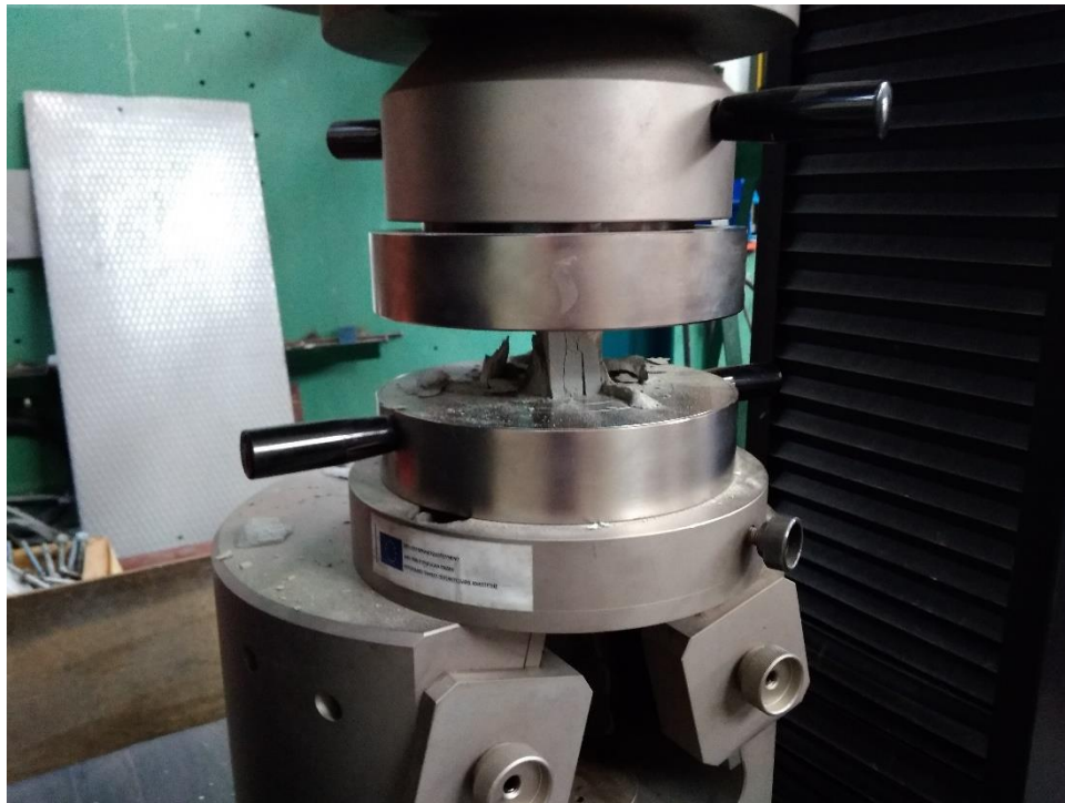
Εικόνα 59. Αστοχία δοκιμίου ιστορικού λιθότυπου
