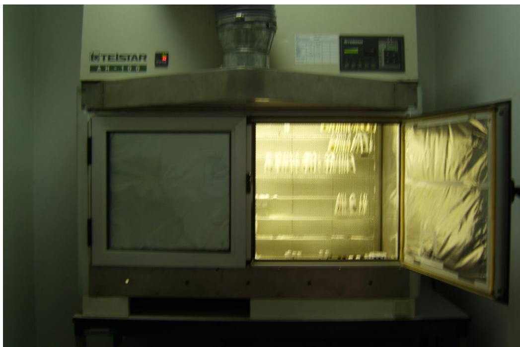
Εικόνα 13. Θάλαμος Αερισμού όπου τοποθετήθηκαν οι εξατμιστήρες CEQA 1, EGVM, CEQA 5 και Qlure-CYP, για τη σύγκριση της κινητικής εκπομπής τους σε ελεγχόμενες συνθήκες.
