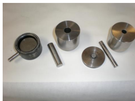
Εικόνα 11. Σύστημα εξαρτημάτων χειροκίνητης υδραυλικής πρέσας για τη Παρασκευή παστιλιών-εξατμιστήρων CEQA.
