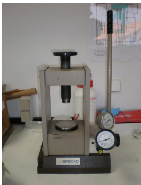
Εικόνα 11. Σύστημα εξαρτημάτων χειροκίνητης υδραυλικής πρέσας για τη Παρασκευή παστιλιών-εξατμιστήρων CEQA.
