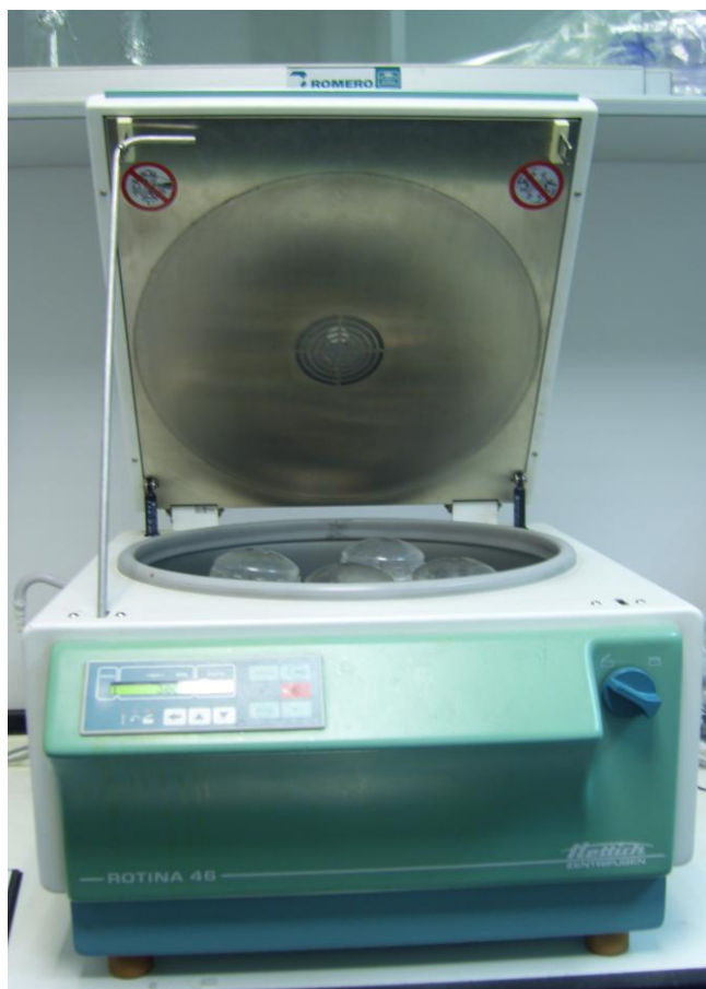
Εικόνα 14. Φυγόκεντρος (POTINA 46, Hettich Zentrifugen, Hettich Lab Technology, Germany) που χρησιμοποιήθηκε για το διαχωρισμό φάσεων των υγρών δειγμάτων των εξατμιστήρων CEQA, ώστε να συλλεχθεί η εναπομείνουσα φερομόνη από το αιώρημα.
