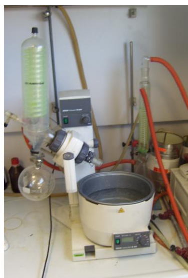
Εικόνα 15. Περιστροφικός εξατμιστήρας , Rotavapor R-200 BÜCHI Laborteknik AG (Germany). Χρησιμοποιήθηκε για την εξάτμιση του διαλύτη κατά την ανάκτηση εναπομείνουσας φερομόνης από τα δείγματα των εξατμιστήρων του εμπορίου.
