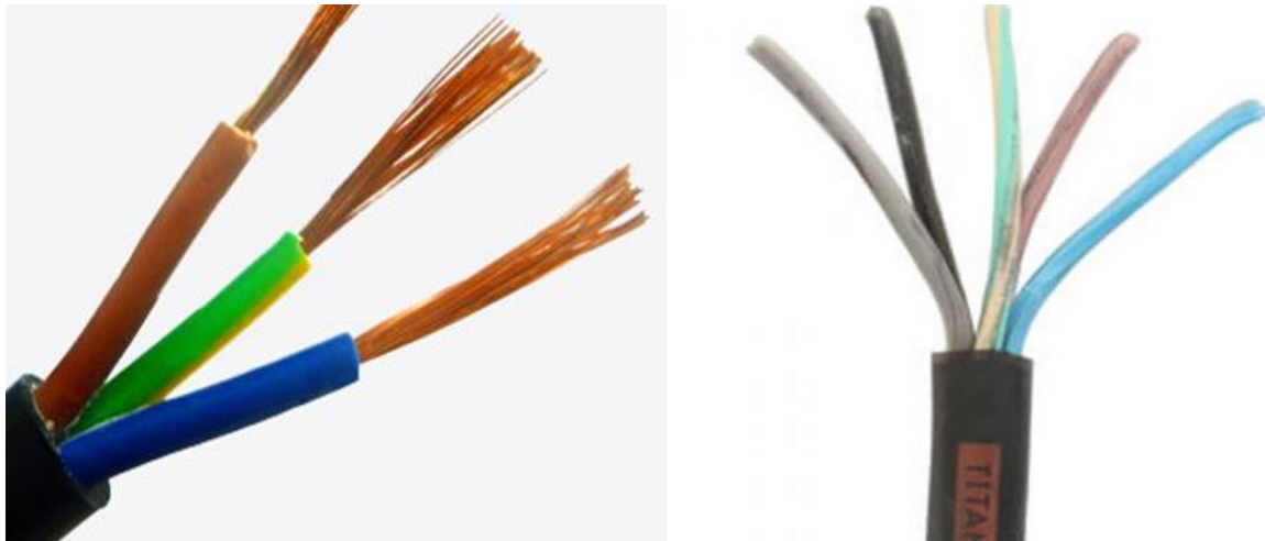
Σχήμα 2.4: Μονοφασικό (αριστερά) και τριφασικό (δεξιά) καλώδιο. Με μπλε χρώμα διακρίνεται ο ουδέτερος αγωγός, με κίτρινο και πράσινο χρώμα ο αγωγός προστασίας. Οι υπόλοιποι αγωγοί αντιστοιχούν στις φάσεις.
