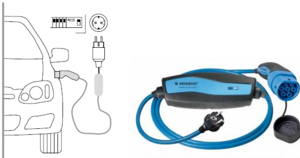
Σχήματα 2.2α και 2.2β: Διάταξη φόρτισης Μεθόδου 2 [16] (αριστερά) και συσκευή IC-CPD (δεξιά) [17]
