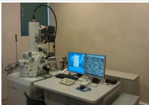
Εικόνα 48 Το μικροσκόπιο σάρωσης ηλεκτρονικής δέσμης (SEM) JEOL JSM-7401F FEG του Ινστιτούτου ΕΚΕΦΕ ΔΗΜΟΚΡΙΤΟΣ
