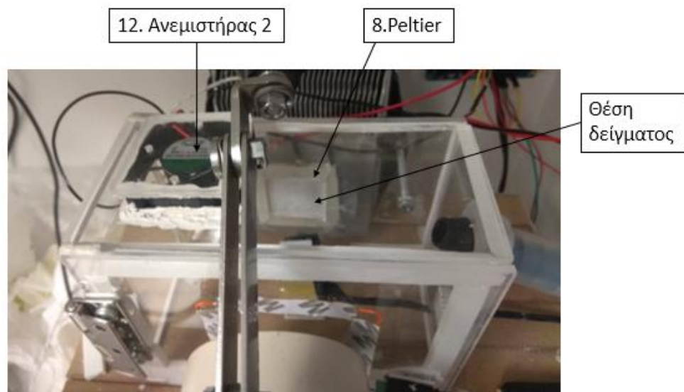
Εικόνα 51 Φωτογραφία μέρους της διάταξης. ο κύριος θάλαμος πειράματος
