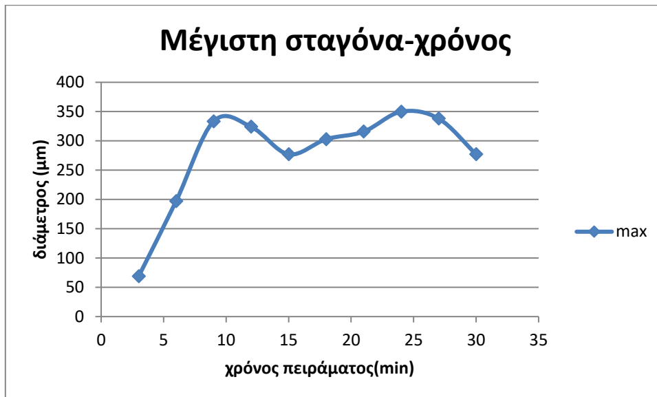
Διάγραμμα 13 Μέγιστη σταγόνα συναρτήσει χρόνου. Επιφάνεια 5 λεπτών εγχάραξης. Στο διάγραμμα φαίνεται ότι όταν μια σταγόνα φτάσει τα 350 μm αποχωρεί λόγω βαρυτικών δυνάμεων από την επιφάνεια και τη θέση της παίρνει κάποια άλλη.
