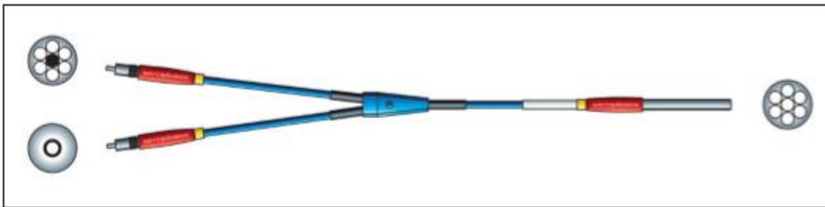
Εικόνα 53 Η ανακλαστική ίνα. Αριστερά η μια δίοδος συνδέεται με την πηγή φωτός ενώ η άλλη με το φωτόμετρο, δεξιά η κεφαλή στοχεύει στο δείγμα, εκπέμπει και συλλέγει φως
