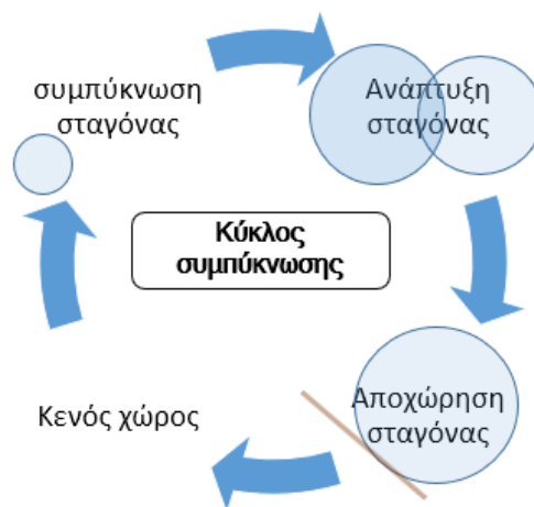
Εικόνα 66 Ο κύκλος συμπύκνωσης
