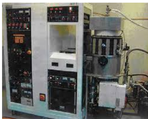
Εικόνα 47 αντιδραστήρας πλάσματος που χρησιμοποιήθηκε για την κατασκευή των επιφανειών
