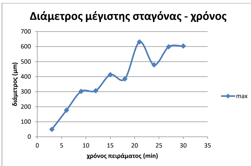
Διάγραμμα 9 Διάμετρος μέγιστης σταγόνας συναρτήσει χρόνου για την υπερυδρόφοβη των δυο λεπτών εγχάραξης
