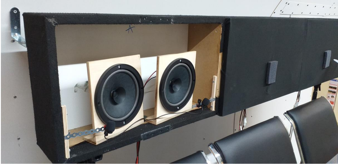
Εικόνα 3.2: Διάταξη μικροφώνων και μεγαφώνων μέσα στο προσκέφαλο του καθίσματος
