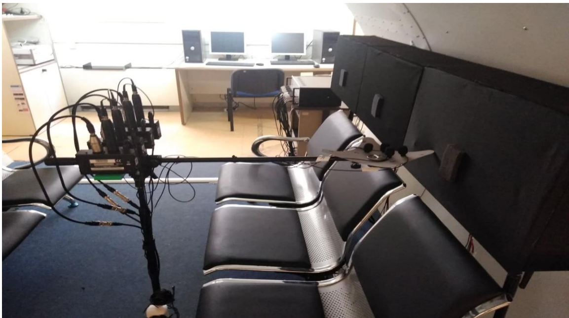
Εικόνα 4.1: Σύστημα ελέγχου απόδοσης του ANC
