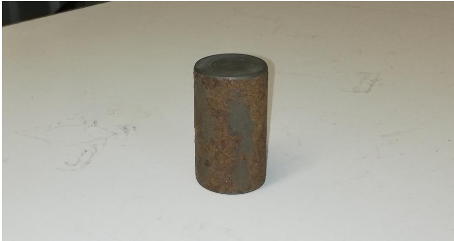
Σχήμα 3.8 Κατάσταση δοκιμίου μετά την έκθεσή του σε διάλυμα θεικού οξέος συγκέντρωσης 20% w/w για 5 ώρες
