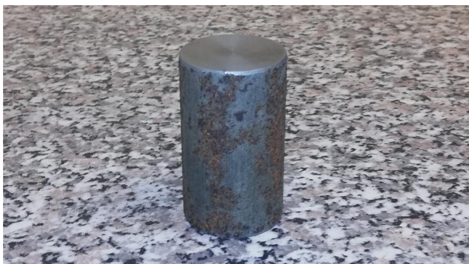
Σχήμα 3.9 Κατάσταση δοκιμίου μετά την έκθεσή του σε διάλυμα υδροχλωρικού οξέος συγκέντρωσης 33% για 10 λεπτά
