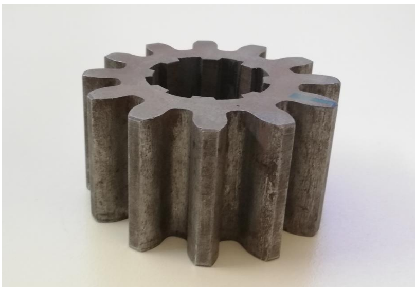
Σχήμα 3.2 Επίδραση οξείδωσης στις κατατομές των τροχών
