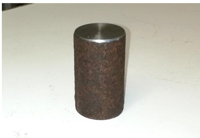
Σχήμα 3.3 Δοκίμιο ελέγχου διάβρωσης
