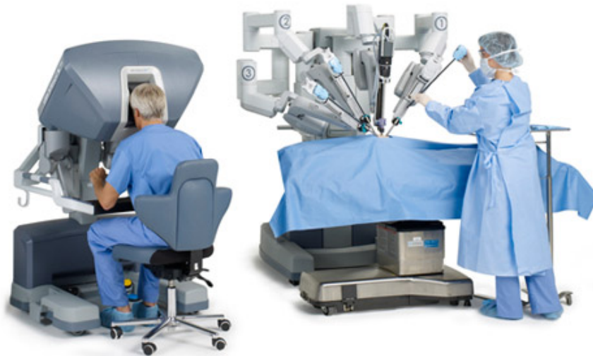
Σχήμα 2.1: Ρομποτικό Χειρουργικό Σύστημα DaVinci (Σύστημα για τηλείατρικής) [30]
