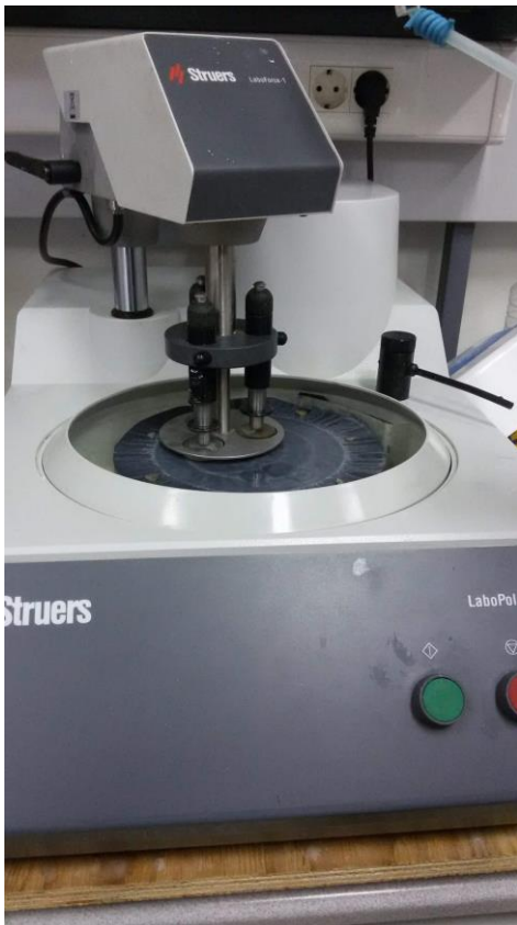
Εικόνα 6.4: Λείανση/στίλβωση και οπτική μικροσκοπία των δοκιμίων
