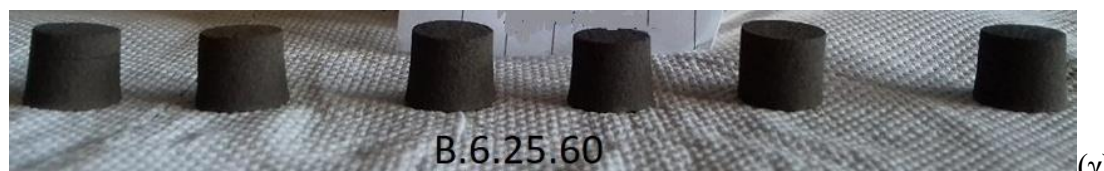
Εικόνα 5.8: Δοκίμια ψημένα στους α) 1200 °C για 30 min και β) 1300 °C για 30 min γ) 1250 °C για 60 min
