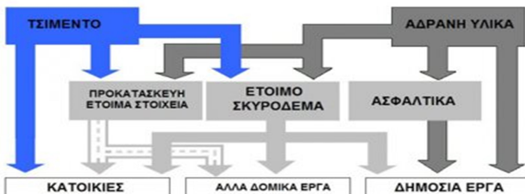
Σχήμα 5.4: Πρώτες ύλες και προϊόντα (πεδία εφαρμογής) της βιομηχανίας τσιμέντου και σκυροδέματος.
