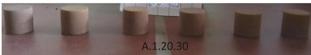
Εικόνα 7.12: Κλίνκερ από φαρίνα Α (Α1.20.30) σε μορφή παστίλιας
