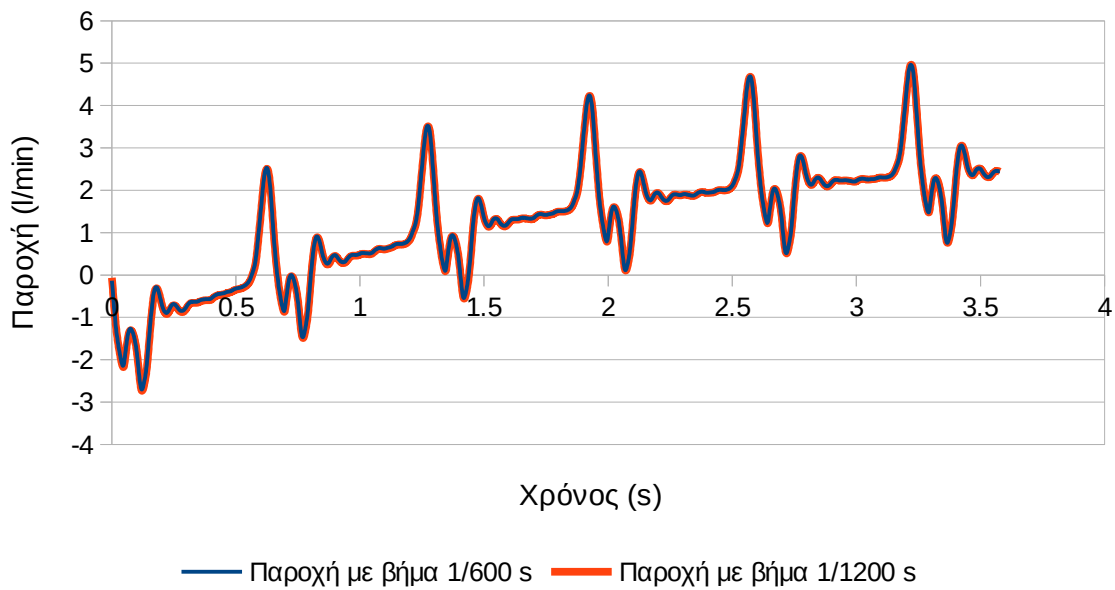
Σχήμα 4.2.26: Σύγκριση παροχής συναρτήσει του χρόνου που υπολογίζεται σε προσομοιώσεις με οριακές συνθήκες πίεσης και με βήμα 1/600 s ή βήμα 1/1200 s για συχνότητα 1.54 Hz
