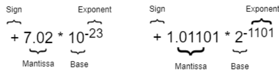
Σχήμα 5: Αναπαράσταση κινητής υποδιαστολής σε δεκαδική και σε δυαδική μορφή
