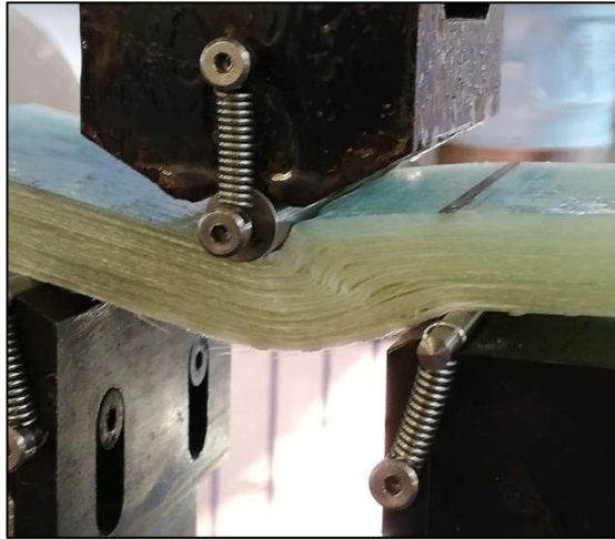
Σχήμα 4.6: Λεπτομέρεια όπου φαίνεται ο τοπικός αποχωρισμός των στρώσεων του δοκιμίου GHU 102
