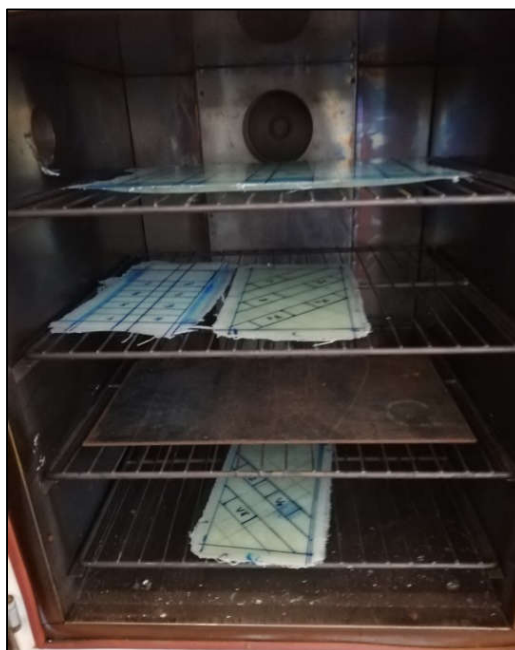
Σχήμα 2.11: Τοποθέτηση πλακών glass στο φούρνο για post curing.
