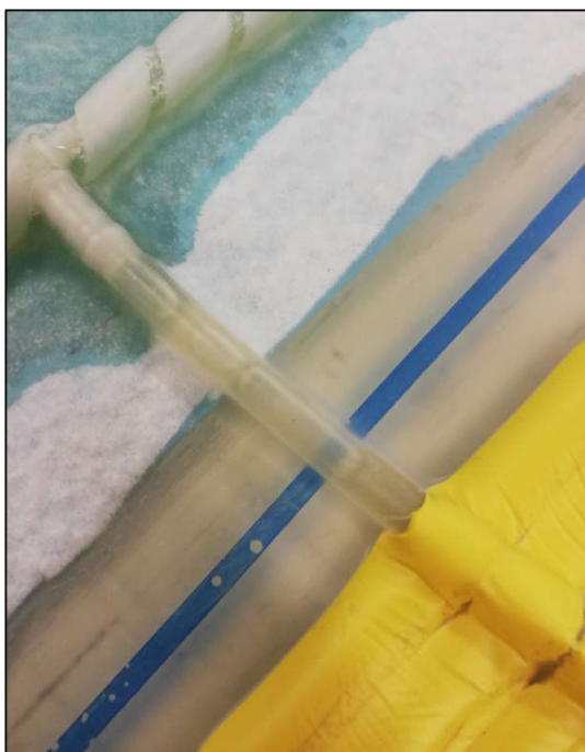
Σχήμα 2.9: Στιγμιότυπο αναρρόφησης της ρητίνης
