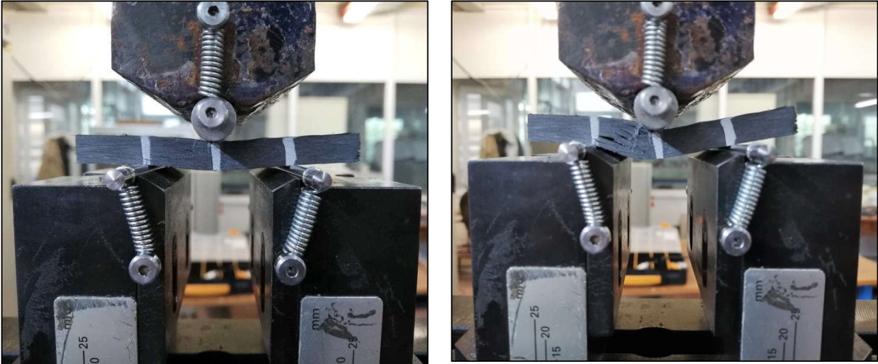
Σχήμα 4.16: Δοκίμιο CHU 54 (a) τη στιγμή επίτευξης μέγιστου φορτίου (b) στο τέλος της δοκιμής
