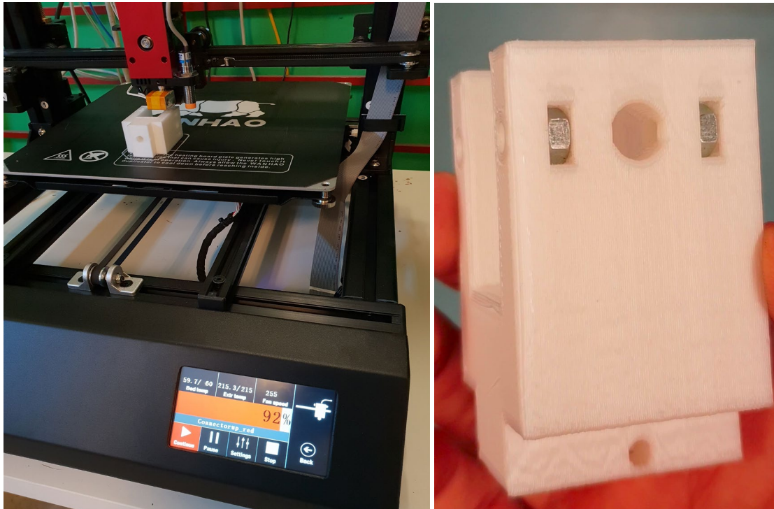
Σχήμα 2-31. (α) Κατασκευή του νέου τεμαχίου στον 3D εκτυπωτή του Εργαστηρίου CSLab, (β) Τελικό τεμάχιο στο οποίο έχουν τοποθετηθεί και τα εξαγωγικά παξιμάδια
