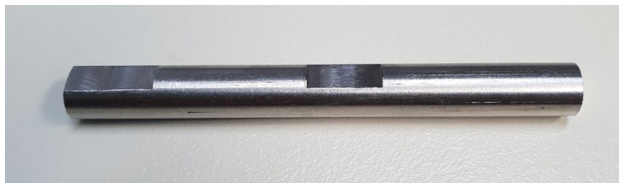
Σχήμα 2-34. Τελική μορφή του νέου άξονα έπειτα από κατεργασία σε μηχάνημα CNC
