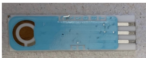
Εικόνα 54: Φθορά ηλεκτροδίου χρυσού με τη χρήση 11-MUA σε αιθανόλη
