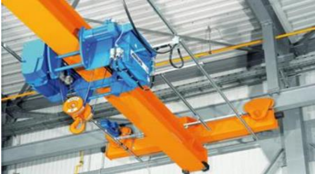
Εικόνα 9.12: Αναρτώμενη γερανογέφυρα μονού φορέα με αναρτώμενο φορτίο βαρούλκο
