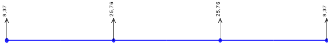
Εικόνα 9.30: Αντιδράσεις μόνο από το ίδιο βάρος της γερανογέφυρας
