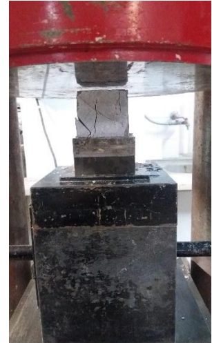
2. 38. Δοκιμή σε θλίψη
