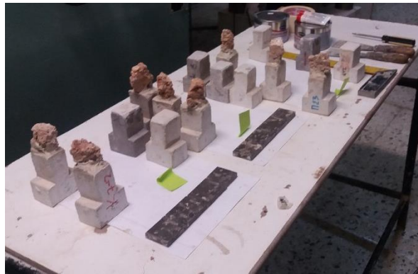
2. 42 Κατά την συγκόλληση των δειγμάτων σε δοκίμια ταφ
