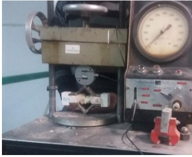
2. 40 Υδραυλική πρέσα-Υπολογισμός εφελκυστικής αντοχής
