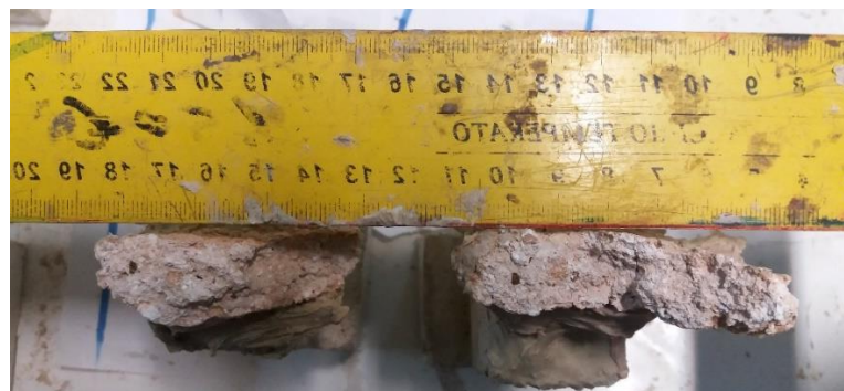
2. 44 Δοκίμια μετά την ρηγμάτωση-Μέτρηση των διαστάσεων των δειγμάτων και υπολογισμός του εμβαδού της ρηγματωμένης επιφάνειας
