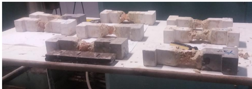
2. 43 Συγκόλληση των δειγμάτων και ταυτόχρονη ευθυγράμμιση τους
