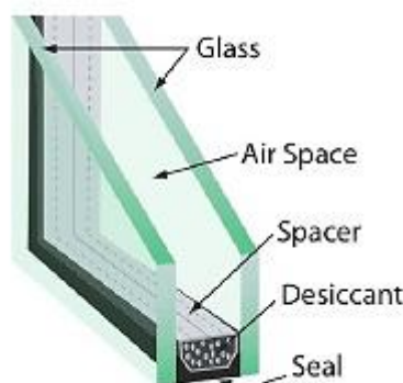
Εικόνα 3.11 Απεικόνιση διπλού υαλοπίνακα σε τομή[41]
