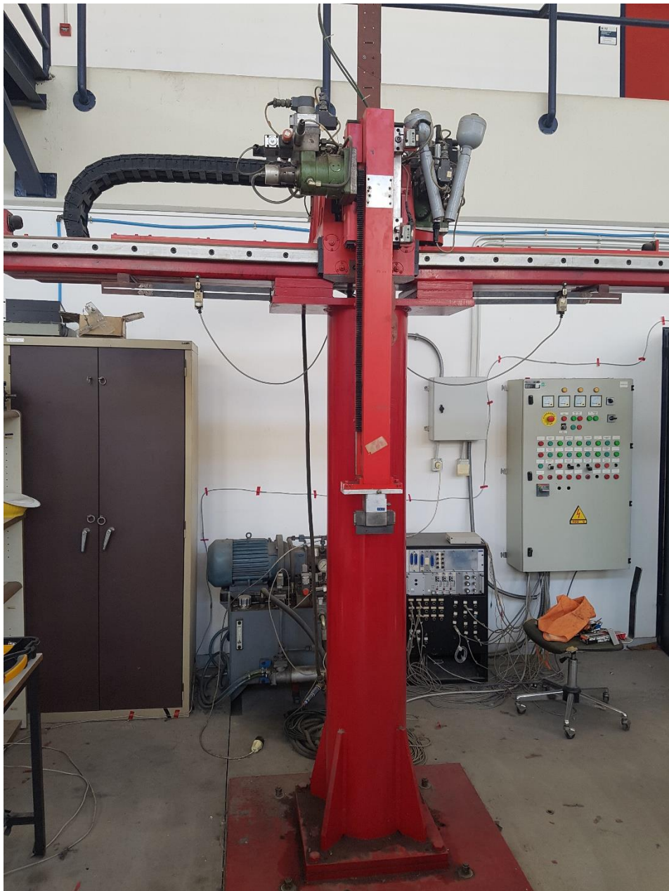
Εικόνα 11. Το παλιό σύστημα μετάδοσης κίνησης με υδραυλικούς κινητήρες και ταχογεννήτριες.
