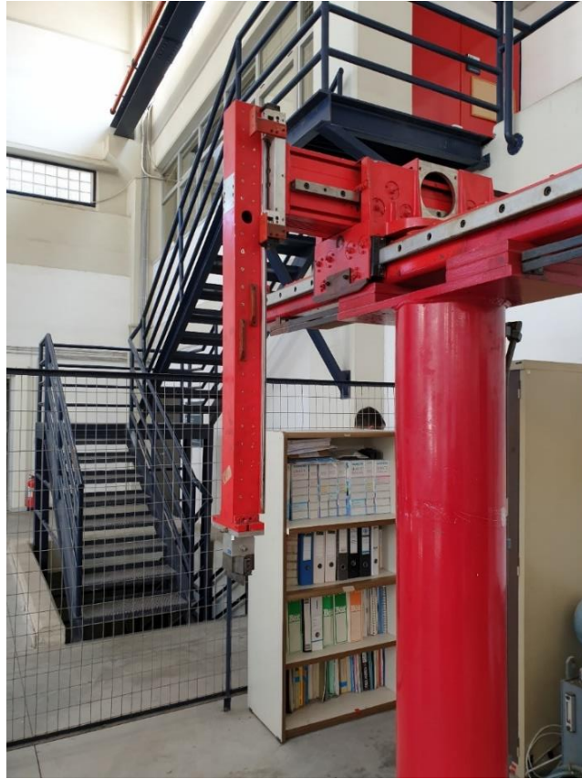
Εικόνα 29. Ο σκελετός του ρομπότ χωρίς κινητήρες και καλωδίωση.
