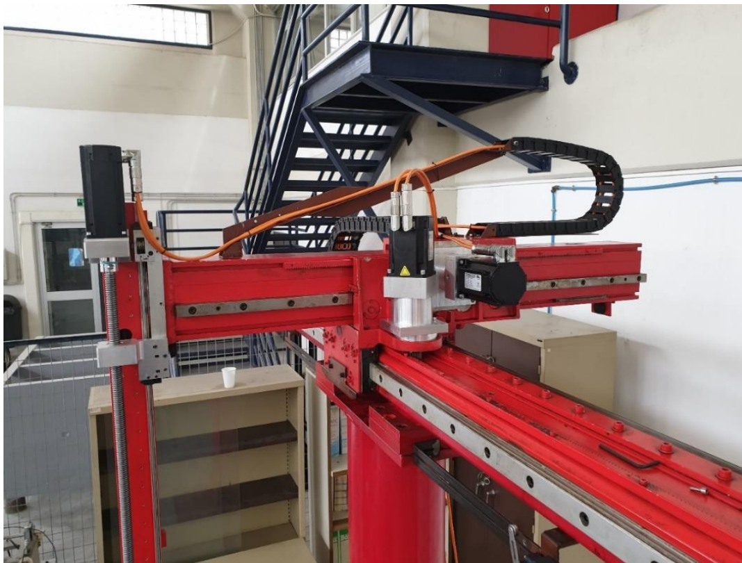
Εικόνα 30. Το ρομπότ με τους νέους σερβοκινητήρες, καλωδιωμένο και έτοιμο για χρήση.
