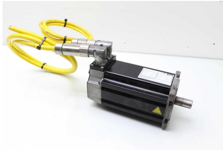
Εικόνα 2. Σερβοκινητήρας με τα καλώδια ισχύος και ανάδρασης
