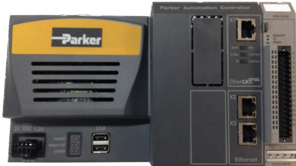
Εικόνα 6. Ο προγραμματιζόμενος ελεγκτής (Motion Controller) όπου χρησιμοποιείται για τον έλεγχο της κίνησης των σερβο-αξόνων.
