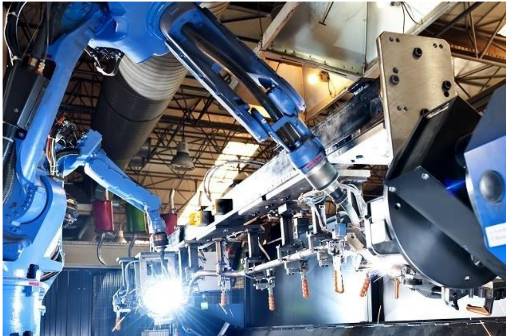
Εικόνα 3. Σύγχρονοι σερβοκινητήρες σε λειτουργία συγκολλήσεων
