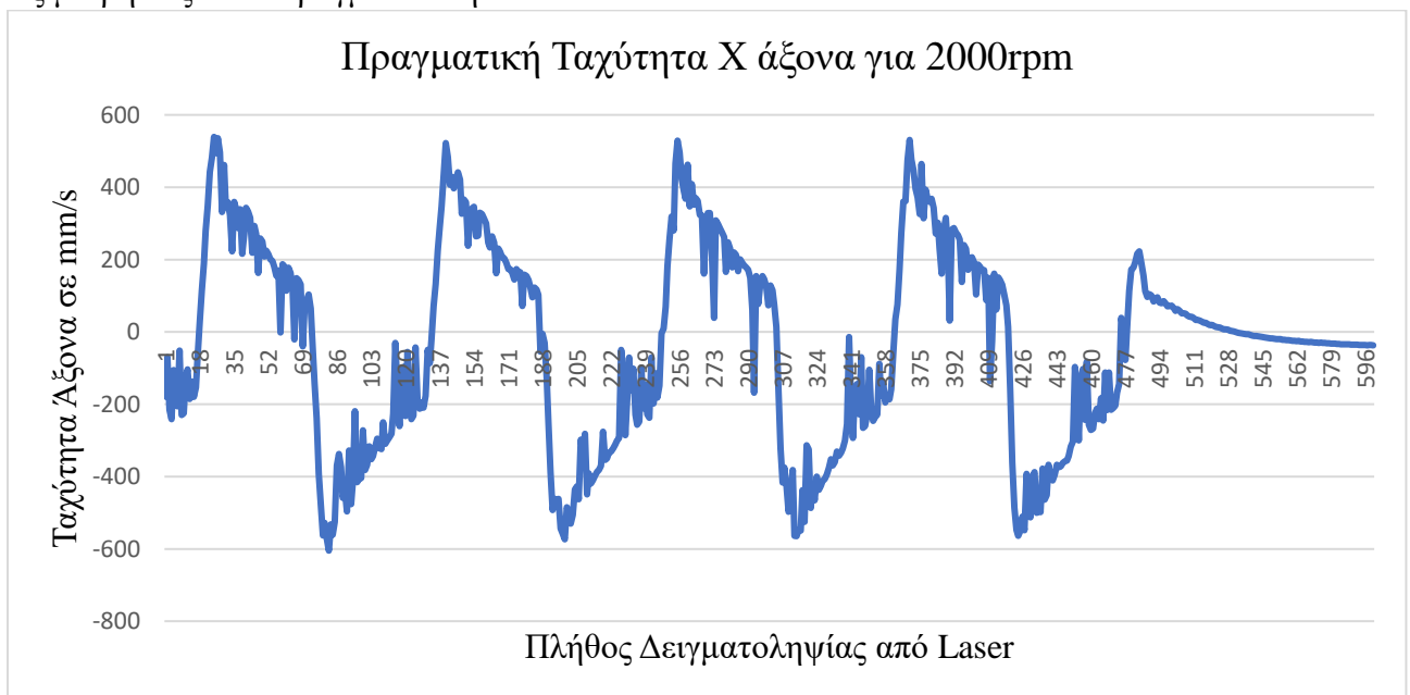
Σχήμα 16. Πραγματική ταχύτητα του άξονα X όπως μετρήθηκε από το Laser.
