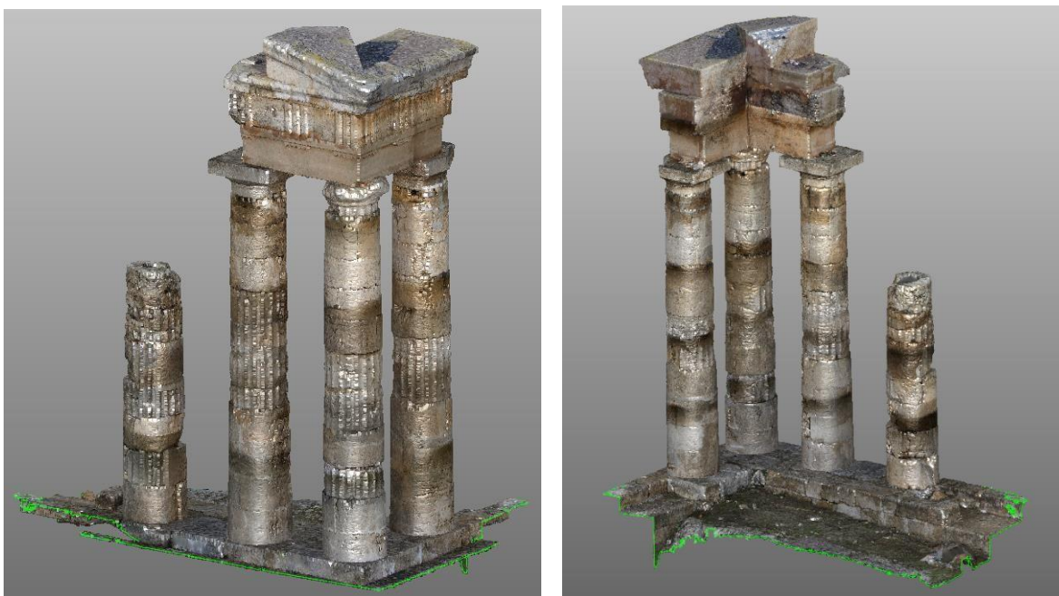
Εικόνα 25. Τρισδιάστατη ψηφιακή αποτύπωση του μνημείου από το Εργαστήριο Φωτογραμμετρίας του Ε.Μ.Π.
