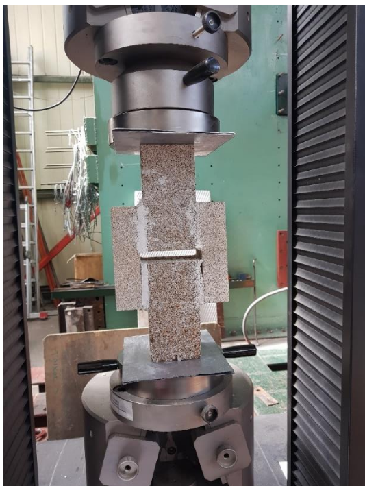
Εικόνα 22. Πειραματικός προσδιορισμός της συνάφειας λίθου – κονιάματος στο εργαστήριο
