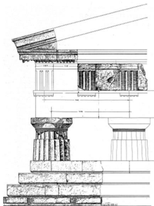
Εικόνα 11. Συμπυγμένη όψη γωνίας του ναού μετά την αναστήλωση Paolini (Paolini, PD 219, in Livadioti and Rocco 1996).
