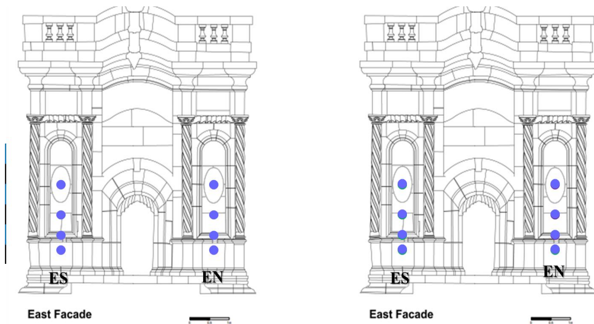
Εικόνα 19 Δειγματοληψία στη Ανατολικής Όψης, κονιάματα συμπλήρωσης (αριστερά) και αρμού (δεξιά)
