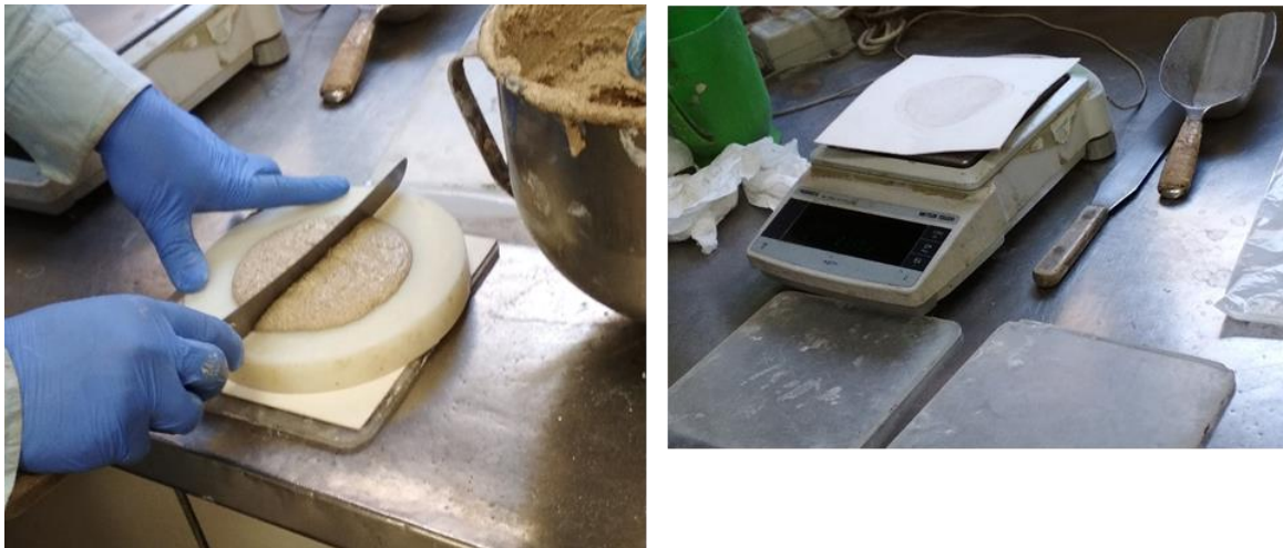
Εικόνα 13 Προσδιορισμός συγκρατούμενου νερού νωπού κονιάματος
