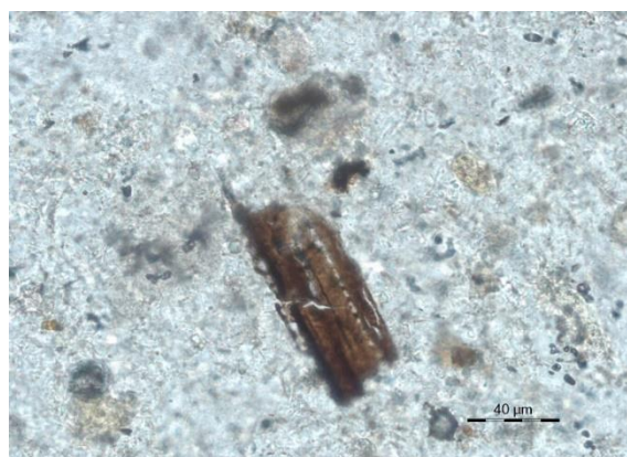
Εικόνα 81 Στοιχεία κάρβουνου (δείγμα JHS_MN5_jm_135 με παράλληλα Nicols μεγέθυνση X500)
