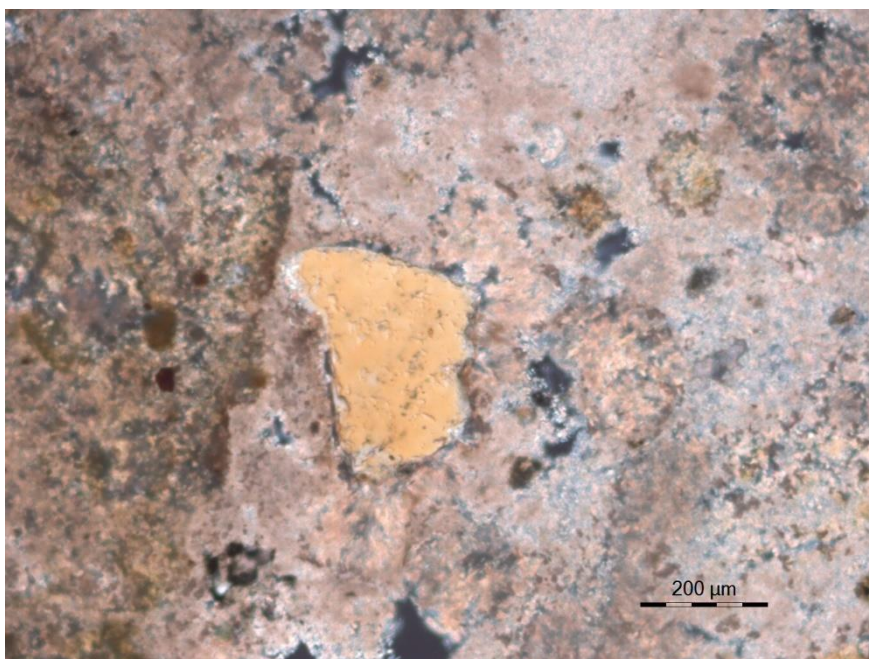
Εικόνα 69 Χαλαζιακό αδρανές (δείγμα JHS_MW_jm_50 με διασταυρωμένα Nicols, μεγέθυνση X100)
