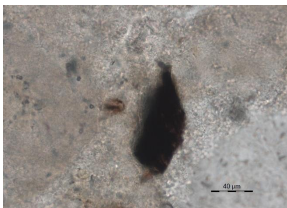
Εικόνα 81 Στοιχεία κάρβουνου (δείγμα JHS_MN5_jm_135 με παράλληλα Nicols μεγέθυνση X500)
