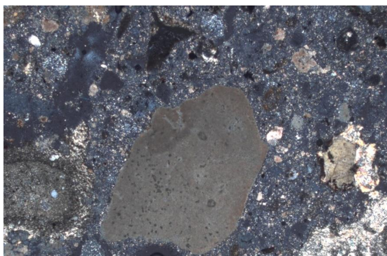
Εικόνα 84 Μεγάλο ασβεστίτικο βιομικροκρυσταλλικό Αδρανής(δείγμα JHS_MN5_jm_135 με διασταυρωμένα Nicols μεγέθυνση X50)
