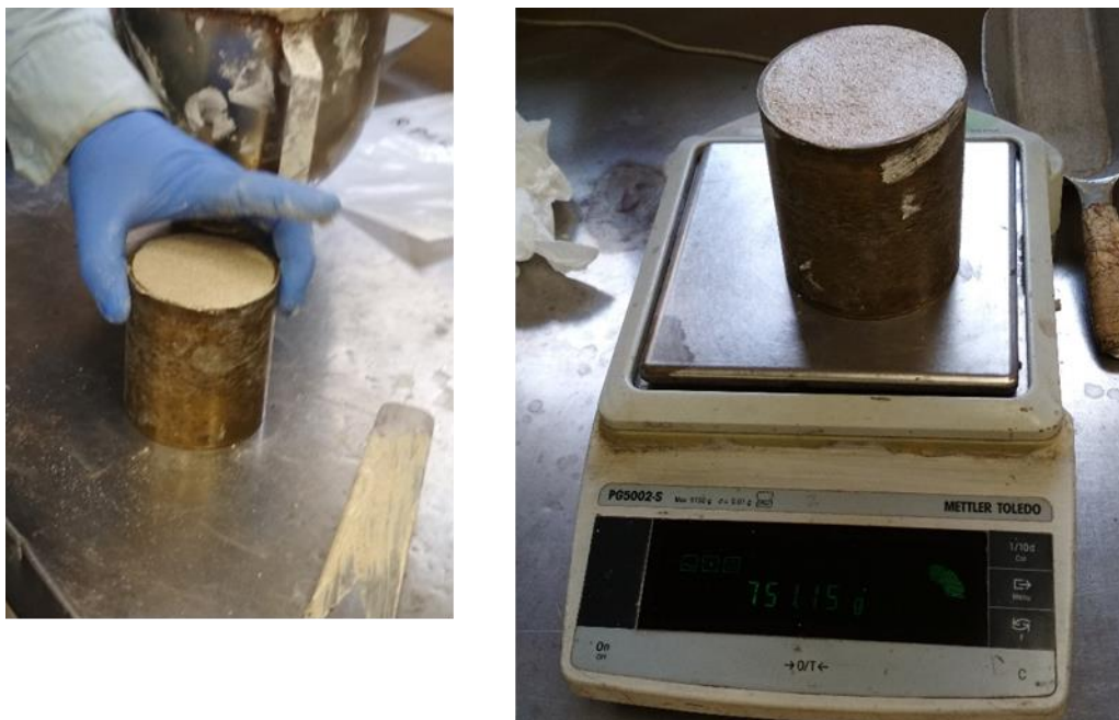
Εικόνα 12 Προσδιορισμός φαινόμενης πυκνότητας νωπού κονιάματος
