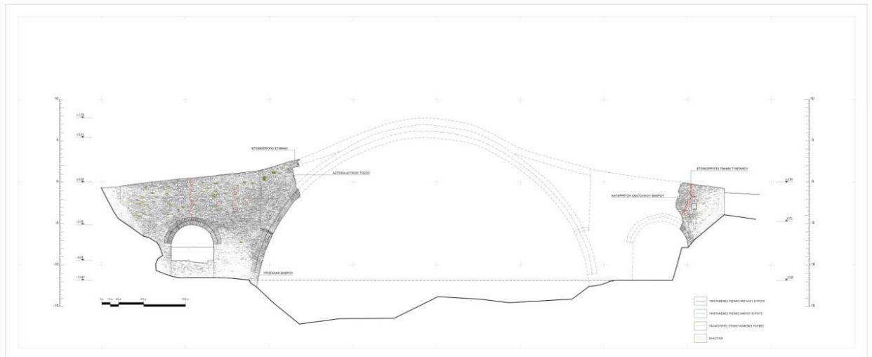
Εικόνα20: Όψη κατάντη γέφυρας μετά την κατάρρευση
