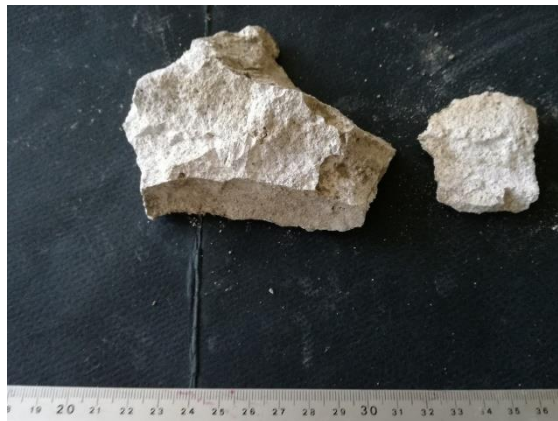
Εικόνα 32: PL.HM_4 : Κονιάμα σύνδεσης λίθων τόξου από την κάτω πλευρά του κάτω θολίτη στο εναπομείναν τμήμα 2
