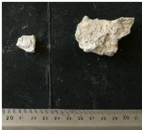
Εικόνα 34: PL.HM_5 : Τελικός αρμός από τον κάτω θολίτη στο εναπομείναν τμήμα 2
