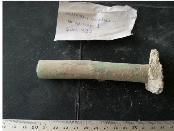
Εικόνα 48: Grout_Tube : Υλικό μέσα από σωληνάκι ενεμάτωσης μεταξύ των θολιτών στο απομεινάρι 1
