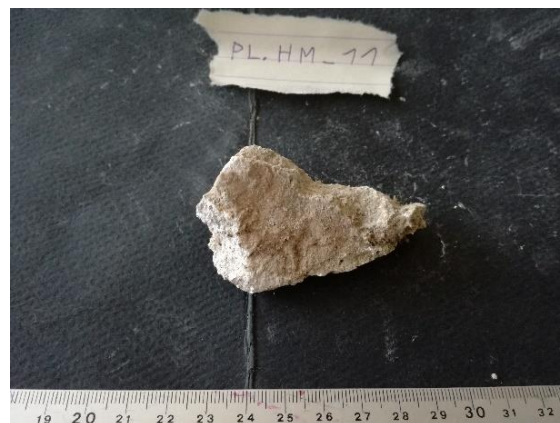
Εικόνα 44: PL.HM_11: Λευκό κονίαμα σύνδεσης 2 θολιτών στο εναπομείναν τμήμα 2, σε επαφή με το τσιμέντο
