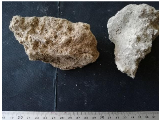
Εικόνα 36: PL.HM_7 : Κονίαμα τυμπάνου, ανάμεσα σε λίθους τυμπάνου
