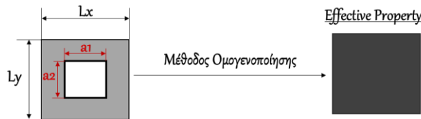
Εικόνα 3.10 Στα αριστερά αναπαρίσταται το πραγματικό unit cell με διαστάσεις οπής \alpha_1, \alpha_2 ενώ στα δεξιά το αντίστοιχο unit cell με τις ισοδύναμες ιδιότητες.
