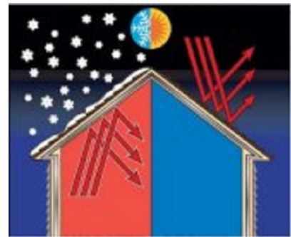
Εικόνα 5-20. Ευεργετικά αποτελέσματα ανακλαστικής μόνωσης[28]
