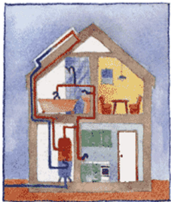
Εικόνα 6-3. Ροή θερμού και κρύου νερού στη διάταξη [28]
