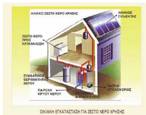
Εικόνα 6-1. Οικιακή εγκατάσταση για ζεστό νερό χρήσης[28]
