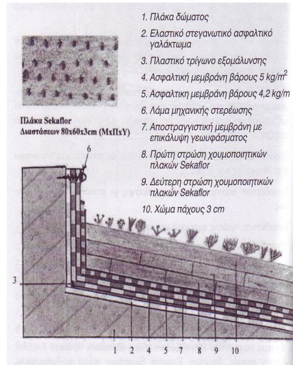
Εικόνα 11-7. Τομή σε φυτεμένο δώμα παλαιάς κατασκευής [12]
