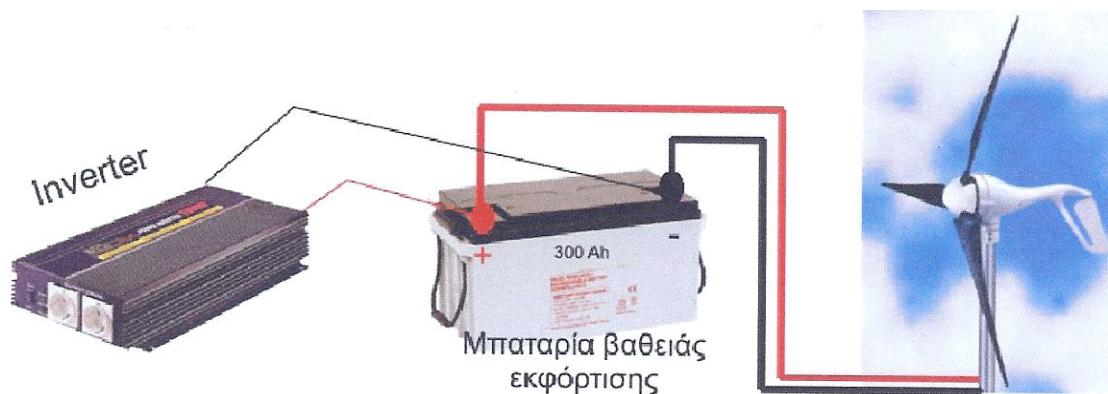
Εικόνα 2-3. Βασικά εξαρτήματα λειτουργίας μίας ανεμογεννήτριας[28]
