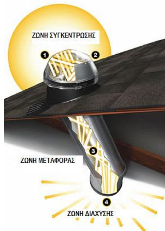
Εικόνα 10-9. Τα βασικά μέρη ενός φωτοσωλήνα[46]
