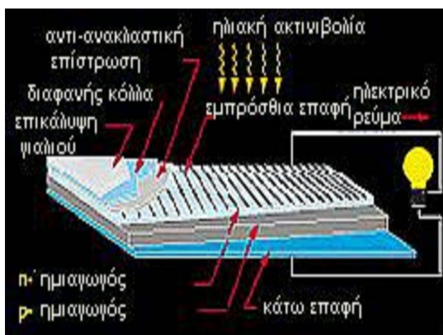
Εικ.9.6. Σύσταση φωτοβολταϊκού κυττάρου[25]
