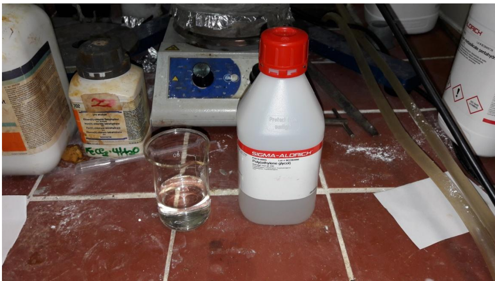
Διάλυμα απιονισμένου νερού, PEG-200 και αμμωνίας ( \text{NH}_4\text{OH} ).
