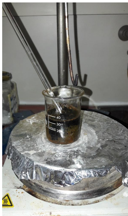
Προσθήκη υδατικού διαλύματος αμμωνίας ( \text{NH}_4\text{OH} ). Αλλαγή του χρώματος του διαλύματος από ανοιχτό πορτοκαλί σε σκούρο μαύρο.
