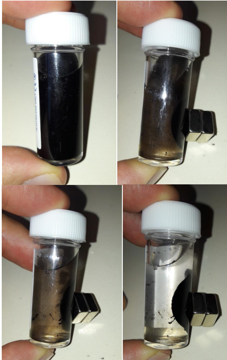
Διαχωρισμός νανοσωματιδίων επικαλυμμένων με λιπιδική μεμβράνη από το εναιώρημα, με χρήση μαγνήτη νεοδυμίου.
