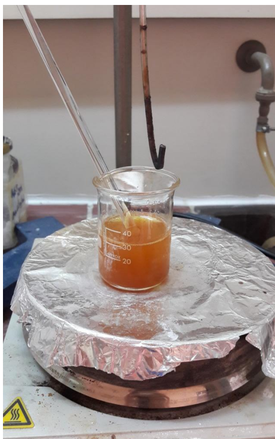
Προσθήκη υδατικού διαλύματος αμμωνίας ( \text{NH}_4\text{OH} ). Αλλαγή του χρώματος του διαλύματος από ανοιχτό πορτοκαλί σε σκούρο μαύρο.
