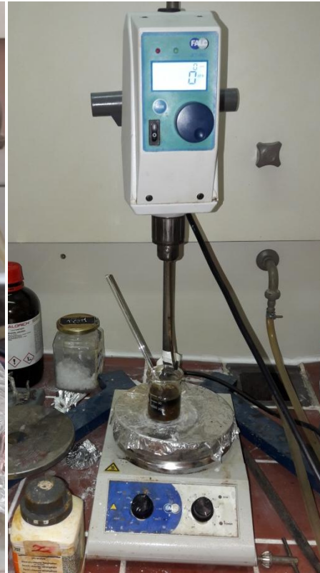
Σιδηρούχο διάλυμα (πορτοκαλί χρώμα). Προσθήκη του διαλύματος του PEG-200 με την αμμωνία, στο σιδηρούχο διάλυμα (μεταβολή σε μαύρο χρώμα).
