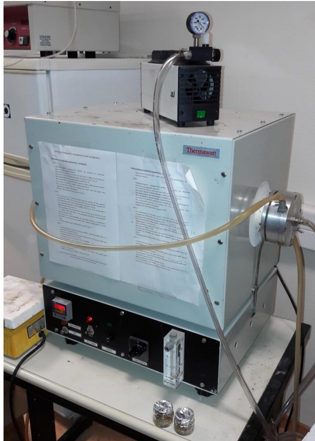
Φούρνος. Ξήρανση των νανοσωματιδίων στους 70^{\circ}\text{C} υπό συνθήκες κενού για 24h.
