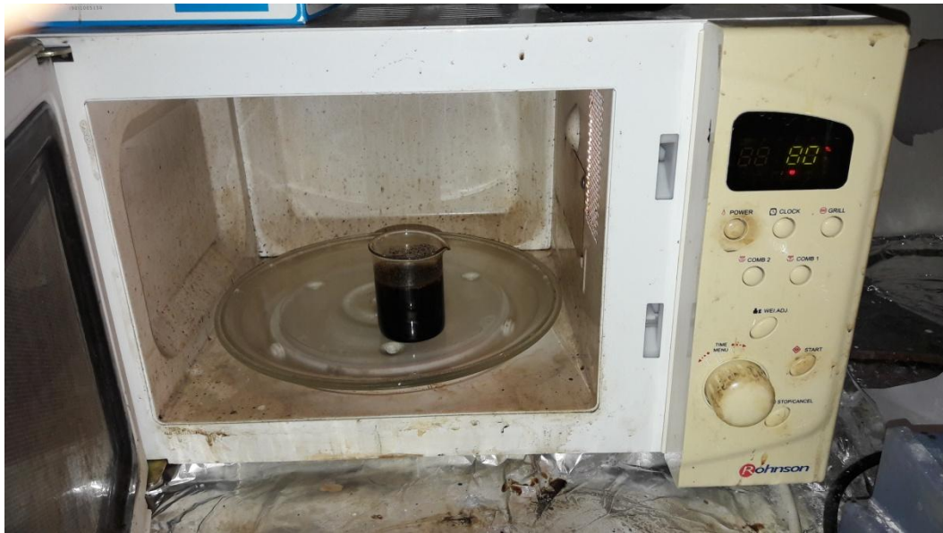
Microwave assisted co-precipitation synthesis με \beta -κυκλοδεξτρίνη. Φούρνος Μικροκυμάτων.
