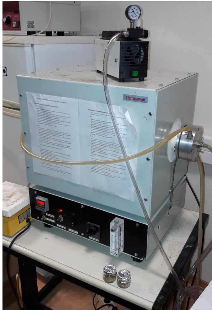
Φούρνος. Ξήρανση των νανοσωματιδίων στους 70°C υπό συνθήκες κενού για 24h.
