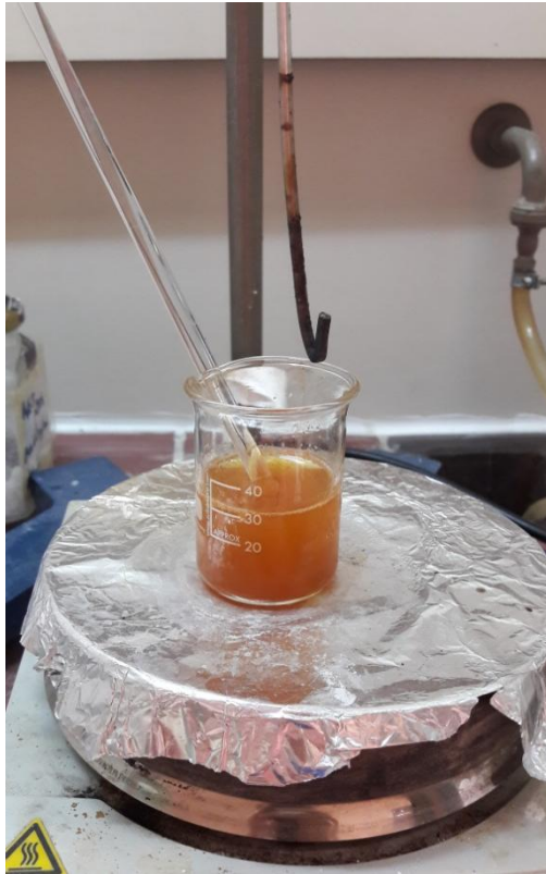
Σιδηρούχο διάλυμα (πορτοκαλί χρώμα). Προσθήκη του διαλύματος του PEG-200 με την αμμωνία, στο σιδηρούχο διάλυμα (μεταβολή σε μαύρο χρώμα).
