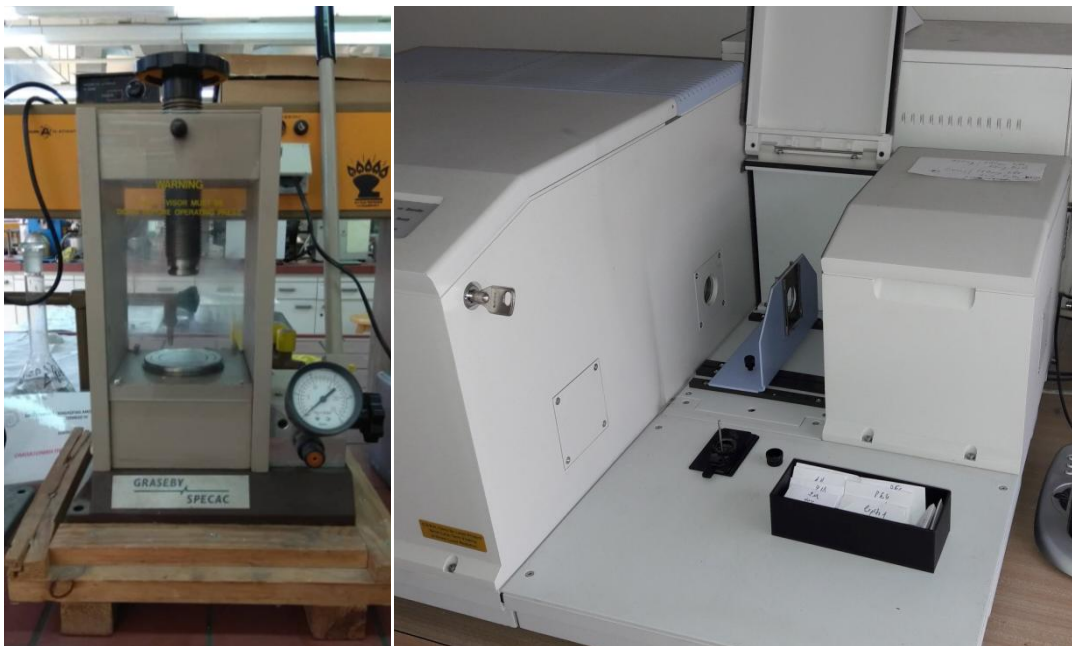
Πρέσα. Παρασκευή πελετών για μελέτη τους στον φασματογράφο FTIR.
