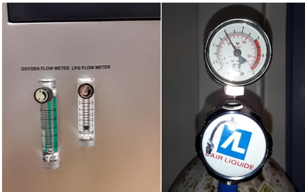
Ρυθμιστές ροής αερίων (οξυγόνου και LPG). Ρυθμιστής πίεσης στην έξοδο της φιάλης O 2 .
