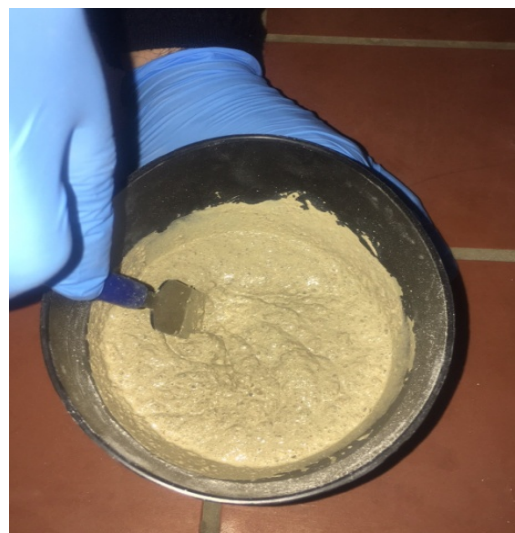
Εικόνα 26: Προσθήκη αδρανούς (άμμος) ως πιο χονδρόκοκκο υλικού στις αναμειγμένες κονίες.
