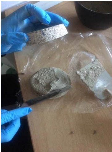
Εικόνα 32: Με μικρή σπάτουλα λειαίνεται η επιφάνεια του κονιάματος
