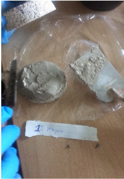
Εικόνα 34: Έτοιμο το κονίαμα αποκατάστασης πάνω στο λίθο αποκατάστασης
