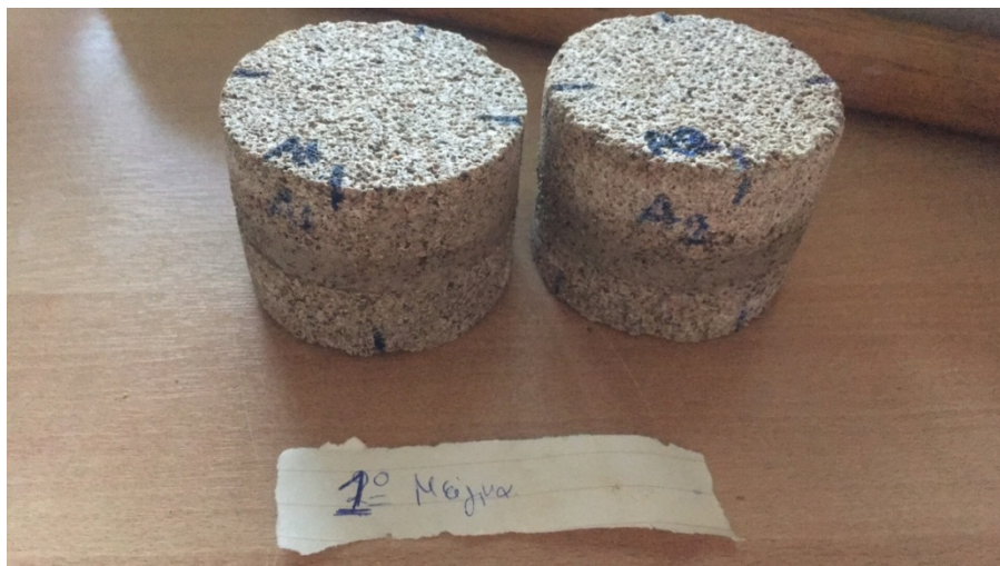
Εικόνα 38: Τελικό στάδιο παρασκευής σύνθετων Λίθου - Κονιάματος αποκατάστασης (A1 & A2 L_NP 12.5)
