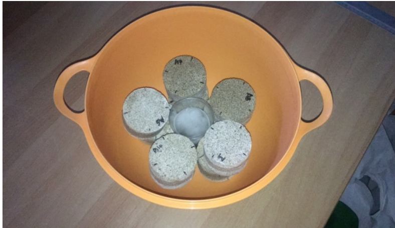
Εικόνα 39: Τοποθέτηση των δέκα σύνθετων σε λεκάνη με νοτισμένο βαμβάκι, μέσα σε πλαστικό ποτηράκι ώστε να παραμείνουν αεροστεγώς κλεισμένα για πέντε μέρες
