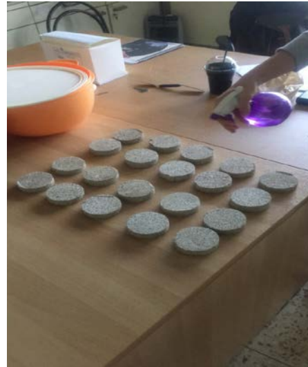
Εικόνα 24: Διαβροχή επιφανειών του λίθου αποκατάστασης Σφουγγάρια Α, με νερό
