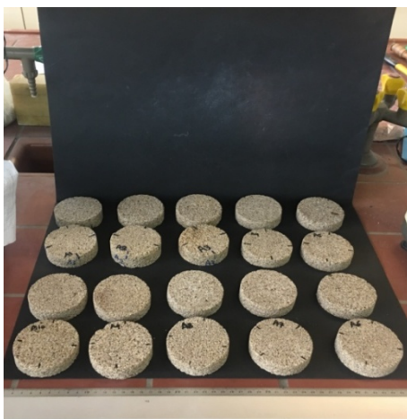
Εικόνα 16: Τα δέκα δοκίμια από τον Λίθο Αποκατάστασης Σφουγγάρια Α, κομμένα στη μέση
