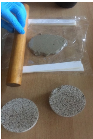
Εικόνα 27: Αυτοσχέδια τεχνική για να γίνει λεία η επιφάνεια του κονιάματος
