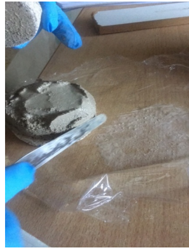
Εικόνα 33: Μαζεύεται η περίσσεια ποσότητα περιμετρικά του κονιάματος
