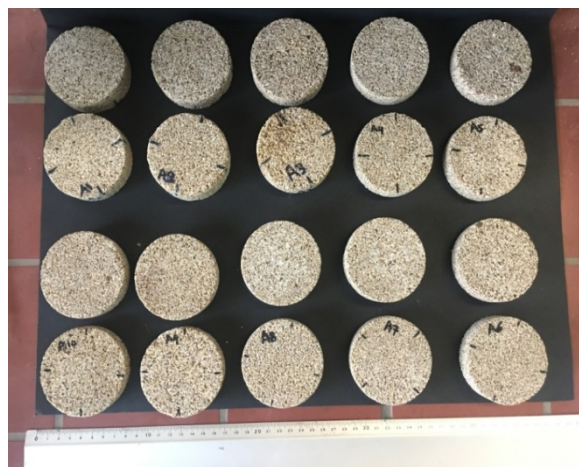
Εικόνα 16: Τα δέκα δοκίμια από τον Λίθο Αποκατάστασης Σφουγγάρια Α, κομμένα στη μέση
