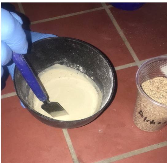
Εικόνα 25: Ανάδευση των δύο κονιών ως πιο λεπτόκοκκα υλικά.
