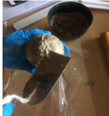
Εικόνα 31: Με την σπάτουλα μαζεύεται όσο κονίαμα περισσεύει περιμετρικά
