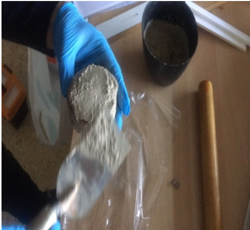
Εικόνα 30: Τοποθέτηση του στον λίθο αποκατάστασης
