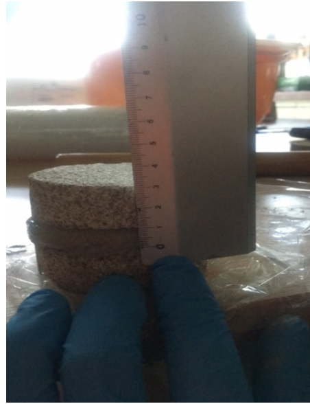
Εικόνα 35: Επιθυμητό πάχος του κονιάματος αποκατάστασης στα 1cm
