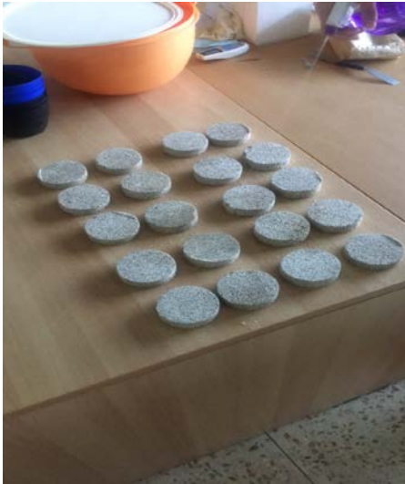
Εικόνα 23: Διαβροχή επιφανειών του λίθου αποκατάστασης Σφουγγάρια Α, με νερό
