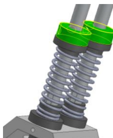
Σχήμα 4-15: Ο σφιγκτήρας προσαρμόζει τη θέση του ελατηρίου μέσω του άνω άκρου αυτού.
