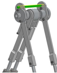
Σχήμα 4-20: Σύνδεσμος ένωσης και μετάδοσης κίνησης από το ένα εξωτερικό πόδι στο άλλο.
