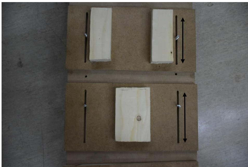
Σχήμα 6-14: Χρήση ρυθμιστών θέσης για προσαρμογή του μήκους βήματος.
