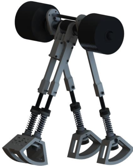
Σχήμα 4-36: Φωτορεαλιστική εικόνα του δίποδου ρομπότ με προσαρτημένες τις επιπρόσθετες μάζες.
