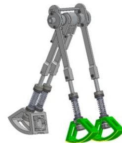
Σχήμα 4-20: Σύνδεσμος ένωσης και μετάδοσης κίνησης από το ένα εξωτερικό πόδι στο άλλο.
