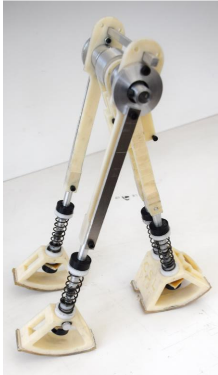
Σχήμα 6-10: Το δίποδο ρομπότ με τα υποστηρικτικά ελάσματα στα εξωτερικά σκέλη.
