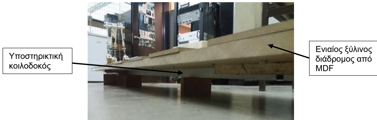
Σχήμα 6-13: Χρήση υποστηρικτικής κοιλοδοκού για αύξηση της δυσκαμψίας.
