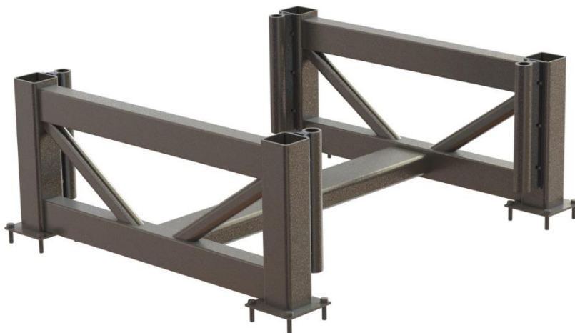
Εικόνα 53. Τελικός σχεδιασμός σκελετού μηχανής
