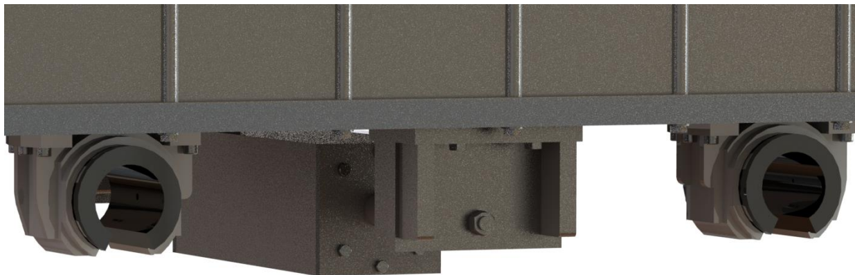
Εικόνα 22. Συναρμολόγημα πλατφόρμας - κυλίνδρου και στοιχείου σύνδεσης
