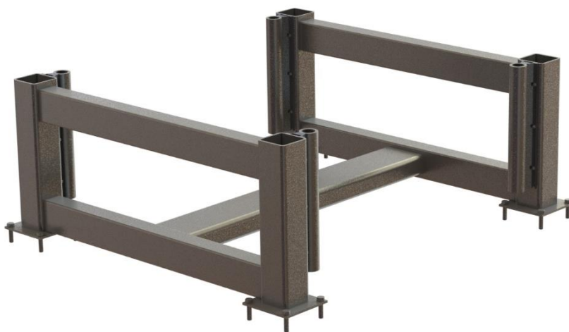
Εικόνα 49. Αρχικός σχεδιασμός σκελετού μηχανής
