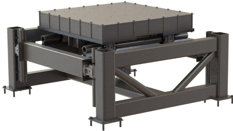
Εικόνα 54. Συναρμολόγημα σεισμικής τράπεζας
