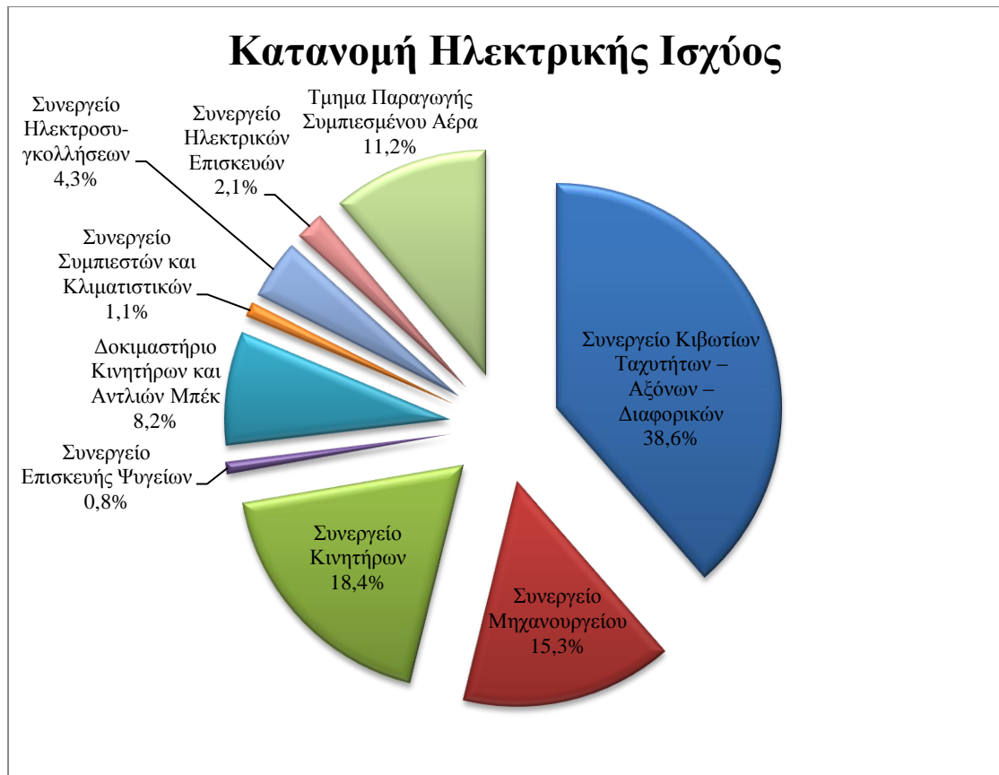
Σχήμα 10.1: Κατανομή ηλεκτρικής ισχύος στην παραγωγική διαδικασία
