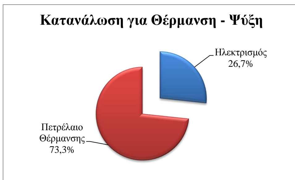
Σχήμα 10.4: Κατανομή ενέργειας για θέρμανση – ψύξη
