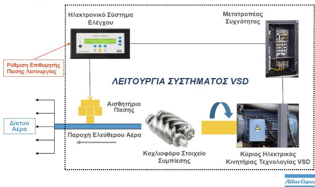
Εικόνα 11.17: Πρότυπη λειτουργία του συστήματος VSD της Atlas Copco
