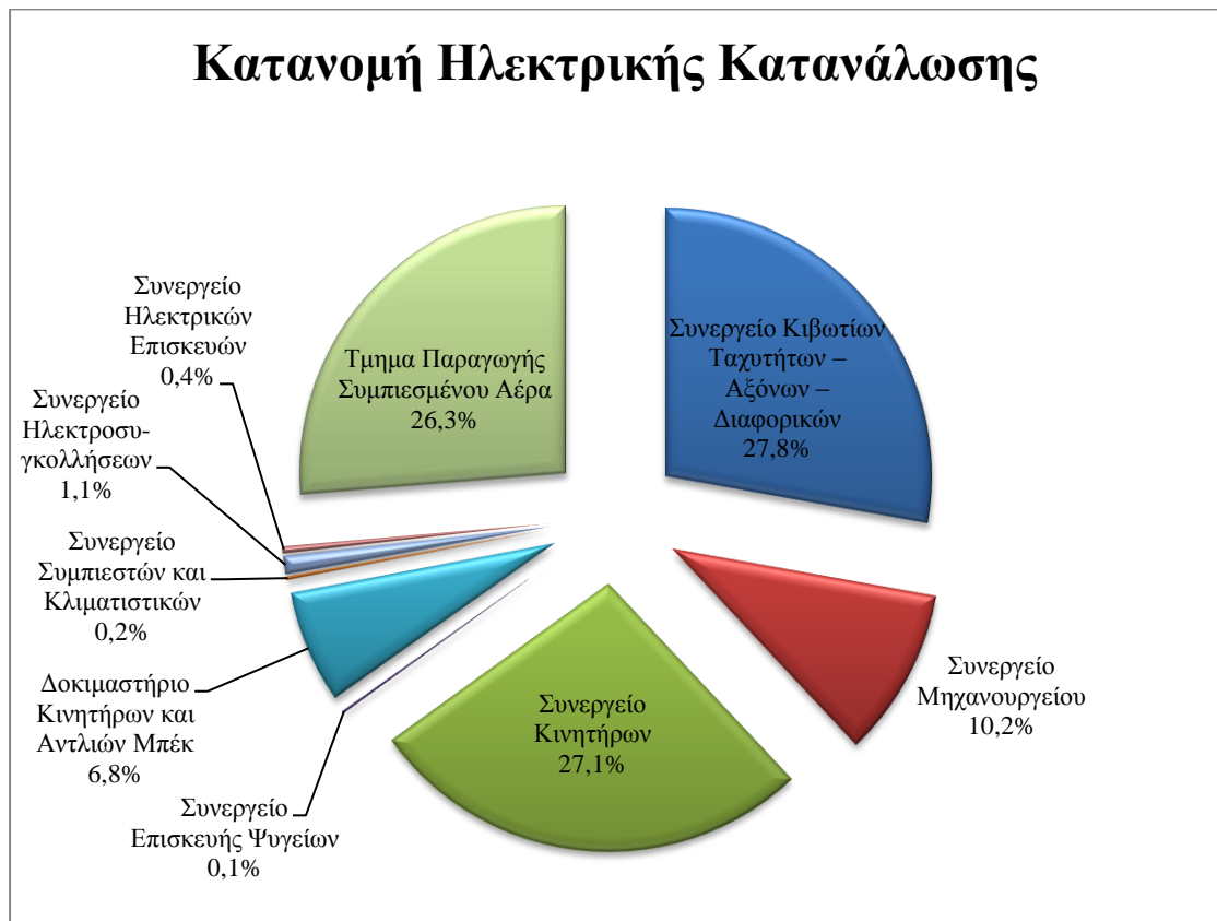
Σχήμα 10.2: Κατανομή ηλεκτρικής ενέργειας στην παραγωγική διαδικασία
