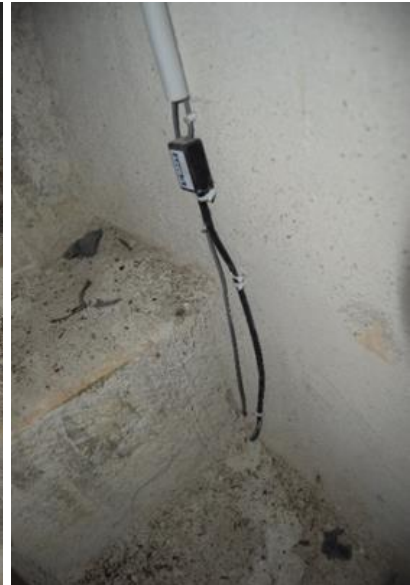
Εικόνα 4.14: Εντοιχισμένα ενσύρματα αισθητήρια DMS4 και DMS5 - κλιμακοστάσια του Ιερού Κουβουκλίου
