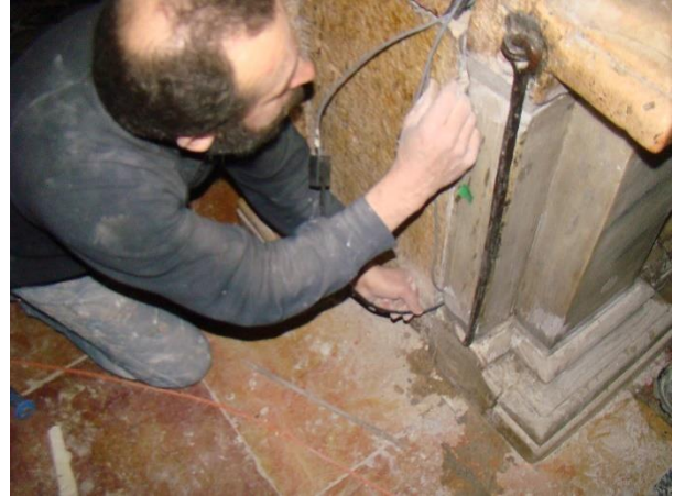
Εικόνα 4.13: Εντοιχισμένα ενσύρματα αισθητήρια DMS2 και DMS3 - είσοδος του Ιερού Κουβουκλίου
