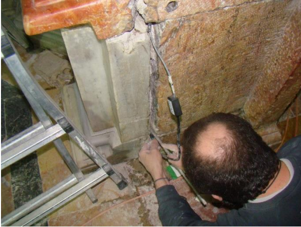
Εικόνα 4.13: Εντοιχισμένα ενσύρματα αισθητήρια DMS2 και DMS3 - είσοδος του Ιερού Κουβουκλίου
