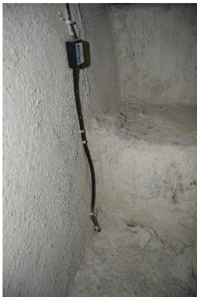
Εικόνα 4.14: Εντοιχισμένα ενσύρματα αισθητήρια DMS4 και DMS5 - κλιμακοστάσια του Ιερού Κουβουκλίου
