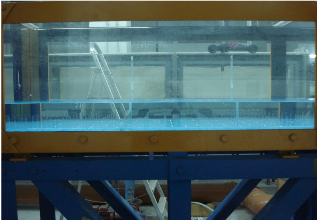
Εικόνα 6: Κλίση 1‰, Πυκνότητα 187 stems/m 2 , Σχετικά μικρή παροχή (2)
