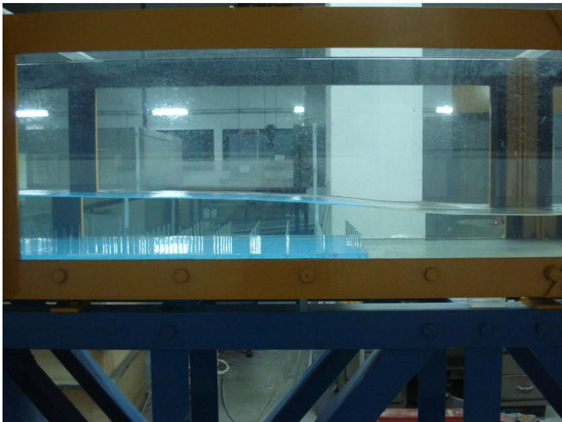
Εικόνα 11: Κλίση 1‰, Πυκνότητα 187 stems/m 2 , Σχετικά μεγάλη παροχή (3)
