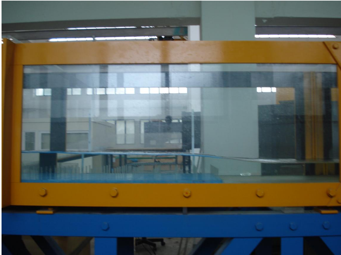
Εικόνα 20: Κλίση 1%, Πυκνότητα 187 stems/m 2 , Σχετικά μεγάλη παροχή (3)
