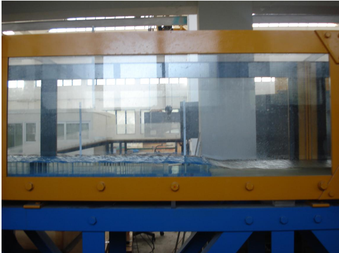
Εικόνα 16: Κλίση 1%, Πυκνότητα 187 stems/m 2 , Σχετικά μικρή παροχή (4)
