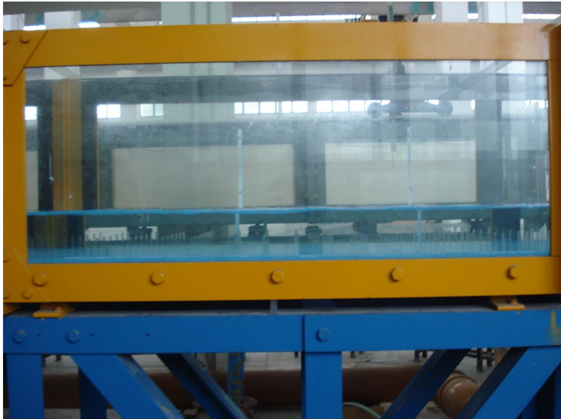
Εικόνα 19: Κλίση 1%, Πυκνότητα 187 stems/m 2 , Σχετικά μεγάλη παροχή (2)
