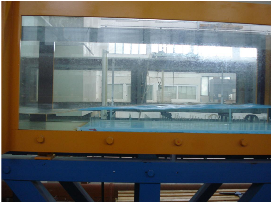
Εικόνα 18: Κλίση 1%, Πυκνότητα 187 stems/m 2 , Σχετικά μεγάλη παροχή (1)
