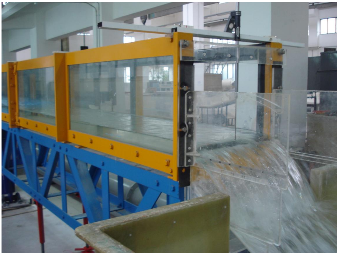
Εικόνα 21: Κλίση 1%, Πυκνότητα 187 stems/m 2 , Σχετικά μεγάλη παροχή (4)
