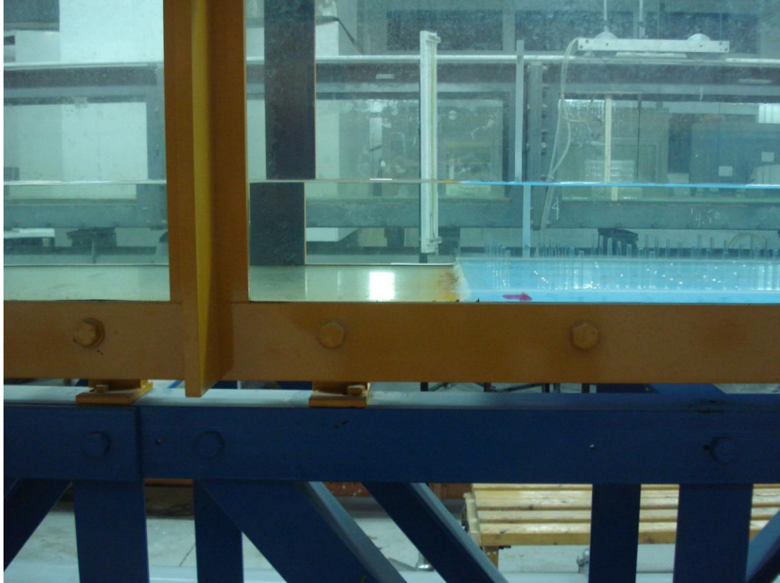
Εικόνα 5: Κλίση 1%, Πυκνότητα 187 stems/m 2 , Σχετικά μικρή παροχή (1)
