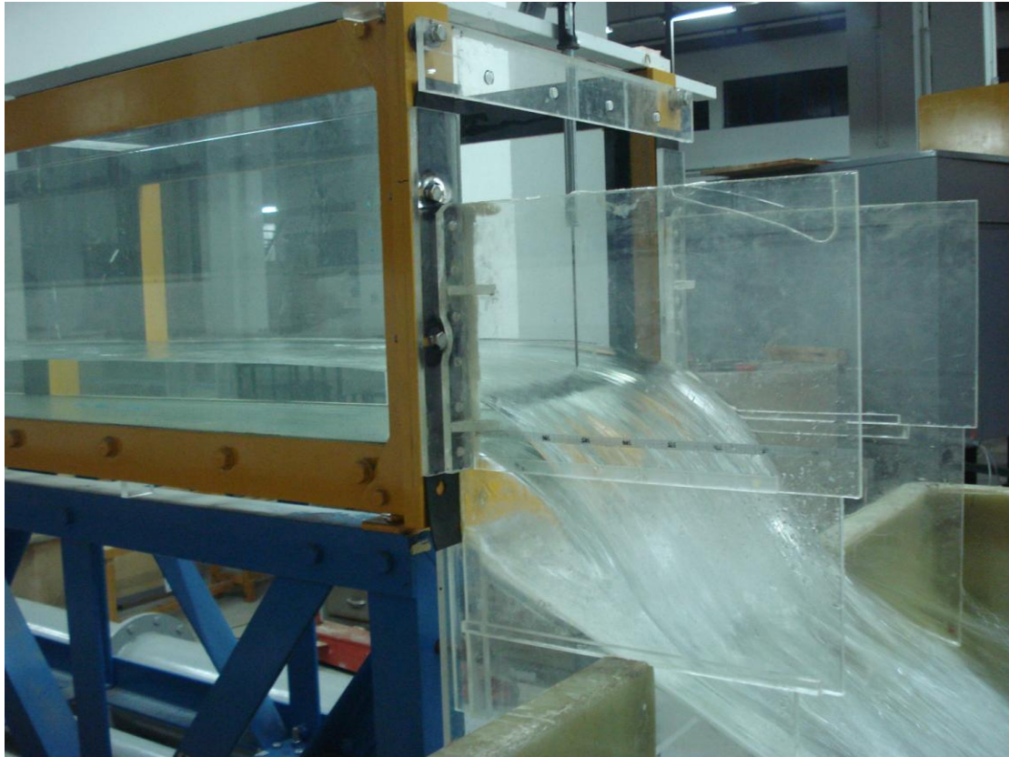
Εικόνα 12: Κλίση 1‰, Πυκνότητα 187 stems/m 2 , Σχετικά μεγάλη παροχή (4)
