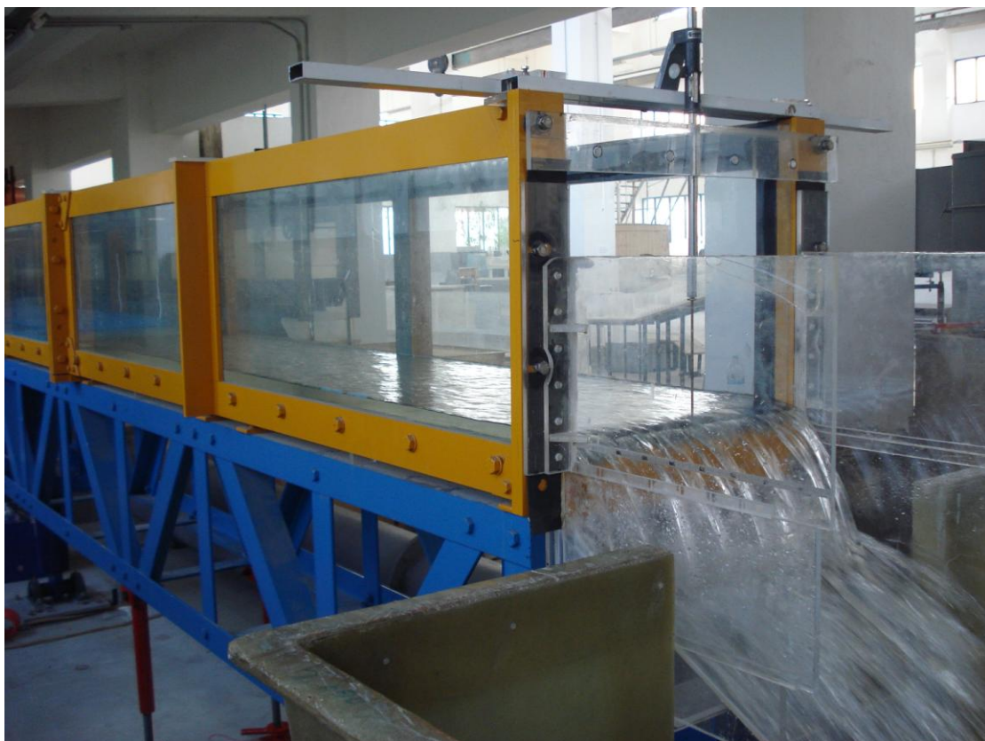
Εικόνα 17: Κλίση 1%, Πυκνότητα 187 stems/m 2 , Σχετικά μικρή παροχή (5)
