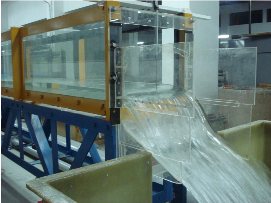
Εικόνα 8: Κλίση 1‰, Πυκνότητα 187 stems/m 2 , Σχετικά μικρή παροχή (4)
