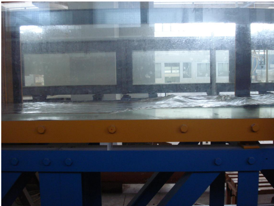
Εικόνα 13: Κλίση 1‰, Πυκνότητα 187 stems/m 2 , Σχετικά μικρή παροχή (1)
