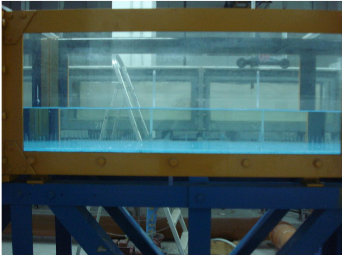
Εικόνα 10: Κλίση 1‰, Πυκνότητα 187 stems/m 2 , Σχετικά μεγάλη παροχή (2)
