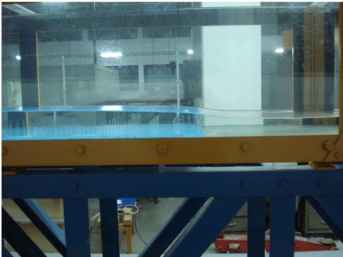
Εικόνα 7: Κλίση 1‰, Πυκνότητα 187 stems/m 2 , Σχετικά μικρή παροχή (3)
