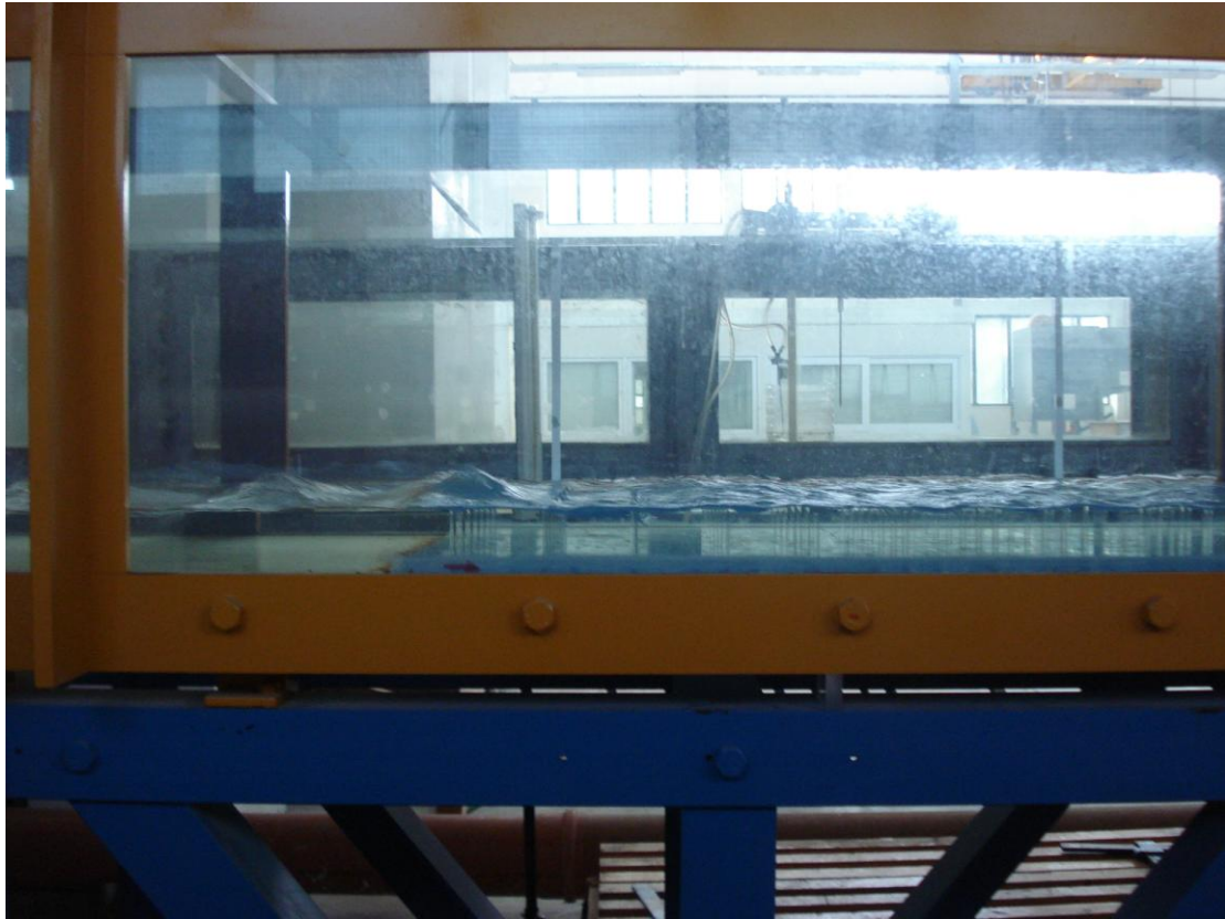
Εικόνα 14: Κλίση 1%, Πυκνότητα 187 stems/m 2 , Σχετικά μικρή παροχή (2)
