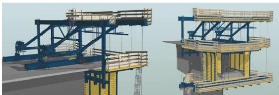
Εικόνα 20 Φορείο σκυροδέτησης σπονδύλων
